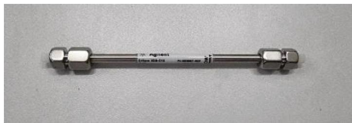
**Slika 12.** Kolona američkog proizvođača Agilent model Eclipse XDB-C18
