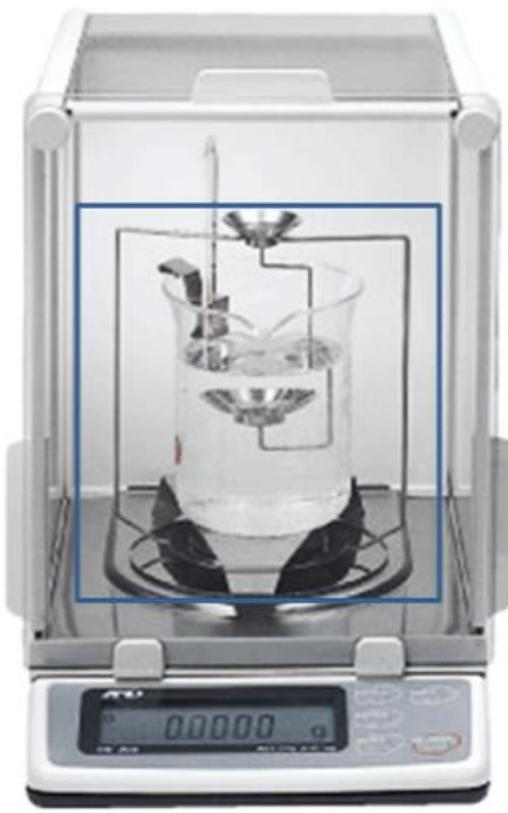
**Slika 5.** Prikaz postava za određivanje gustoće Arhimedovom metodom [16]
