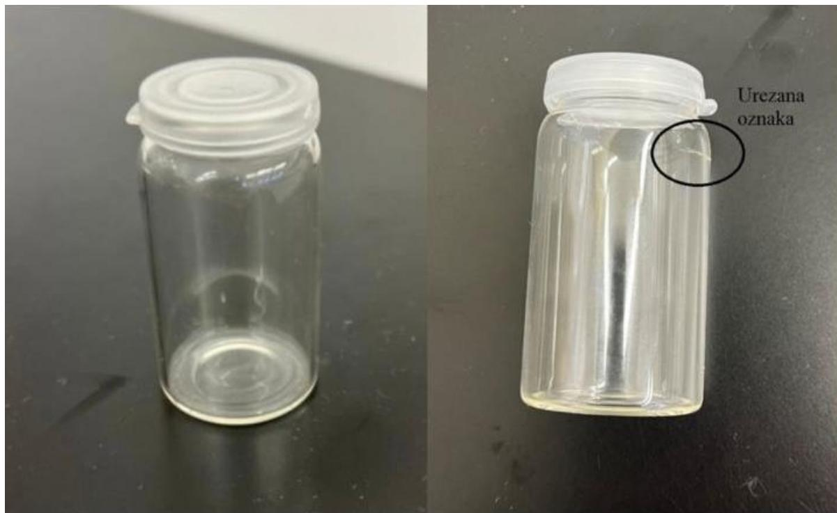
**Slika 10.** Prikaz korištenog improviziranog piknometra s urezаном ознаком
