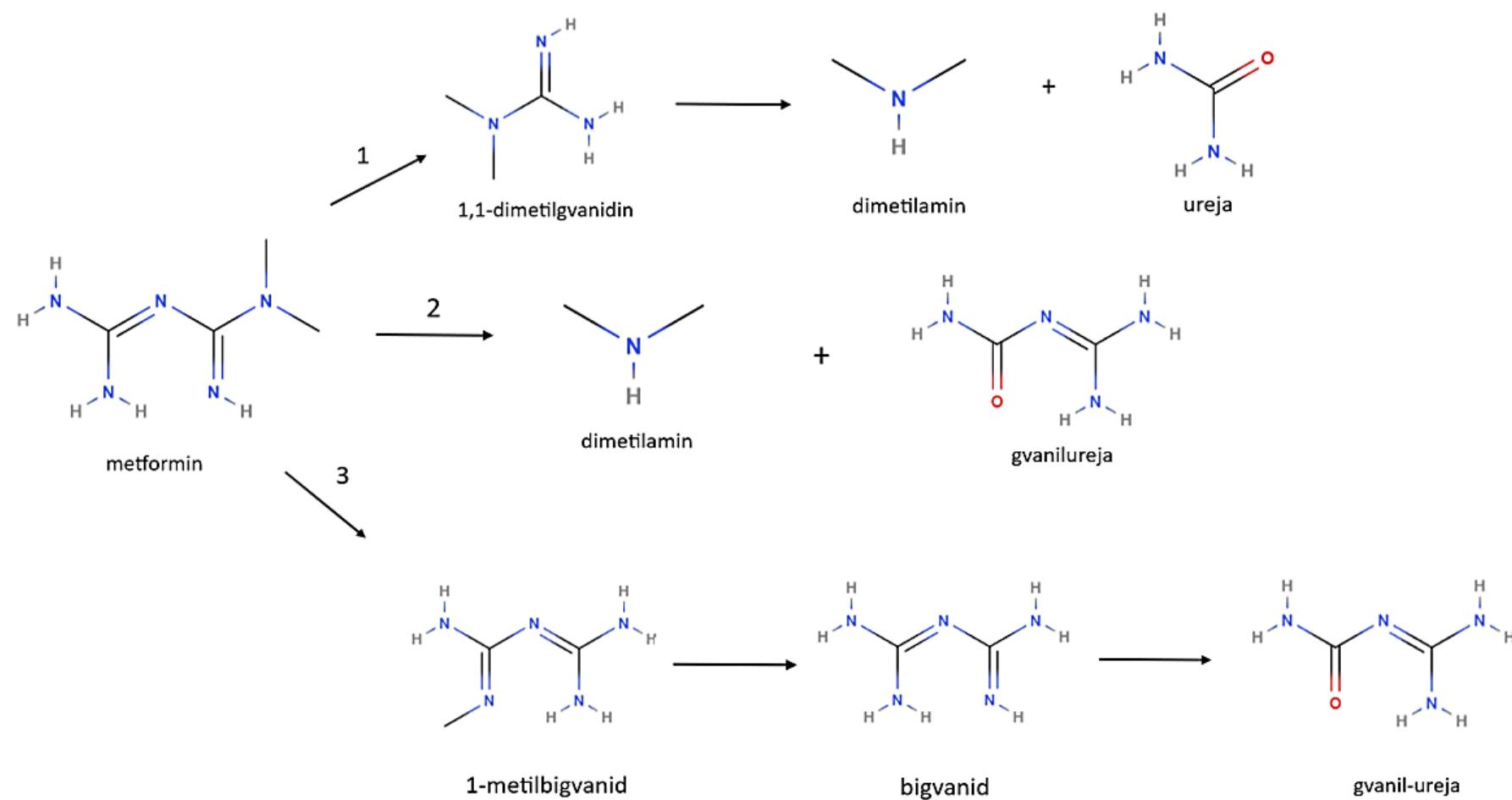
Slika 3.5. Prikaz 3 osnovna procesa biorazgradnje metformina u okolišu [31]
