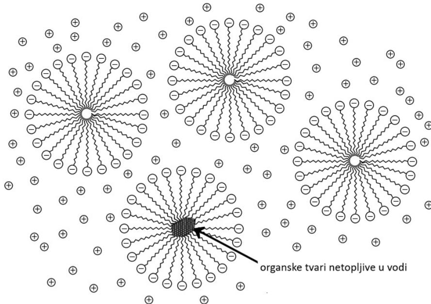
Slika 2.1. Shematski prikaz strukture čestica micela u vodenom mediju [7]
