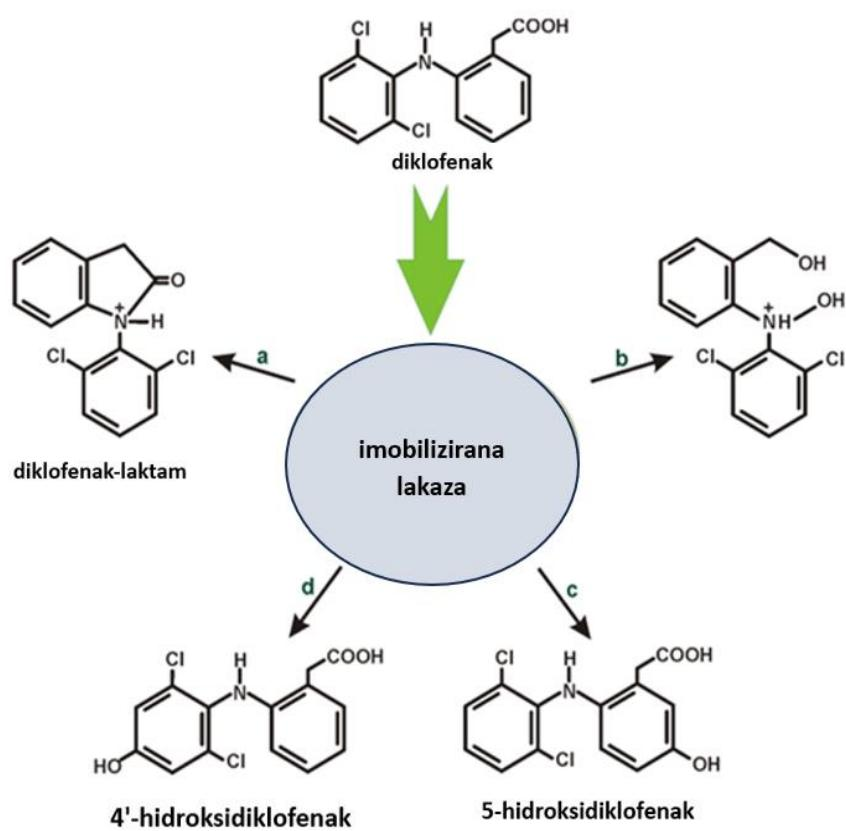
Slika 3.10. Biorazgradnja diklofenaka uz lakazu u imobiliziranom sustavu [19]
