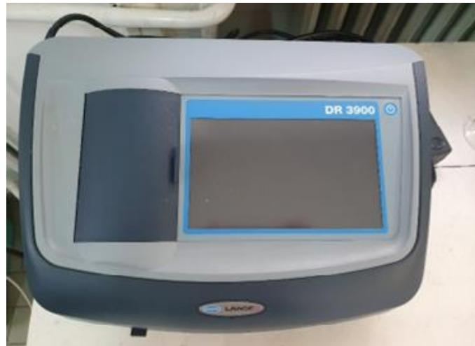
**Slika 5.** Spektrofotometar Hach Lange DR 3900
