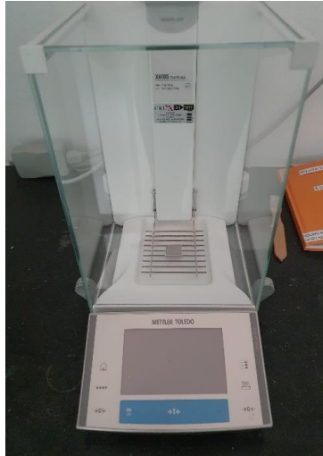
Slika 4. Analitička vaga XA105 DualRange, Mettler Toledo
