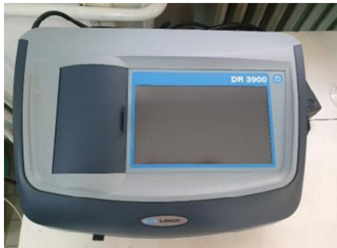
Slika 5. Spektrofotometar Hach Lange DR 3900
