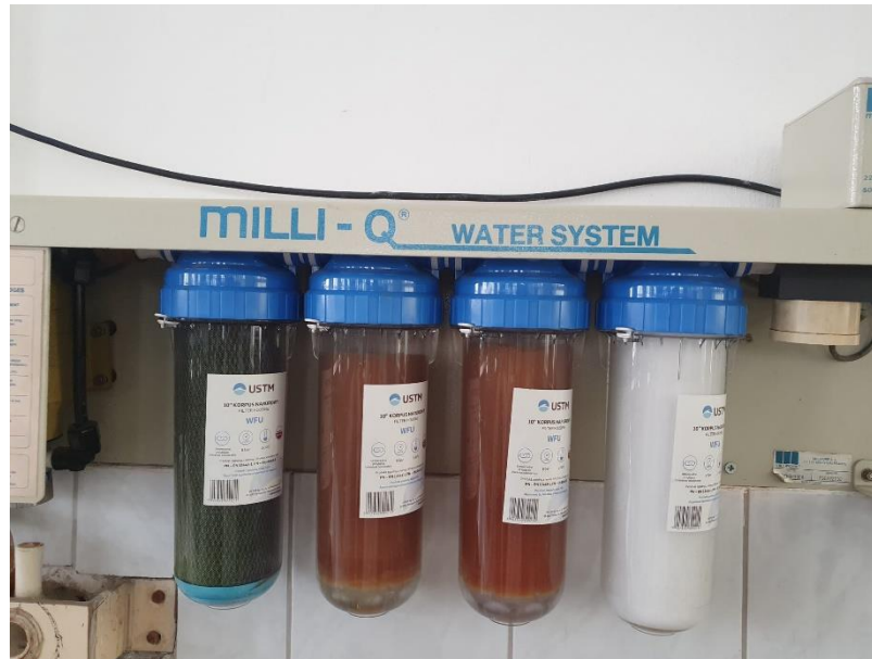
Slika 6. Uređaj za dobivanje MilliQ vode Milli-Q Water System
