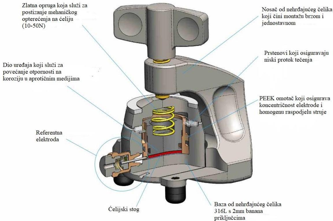
**Slika 3.5** Shema čelije ECC-Ref (EL-Cell, Njemačka) [24]
