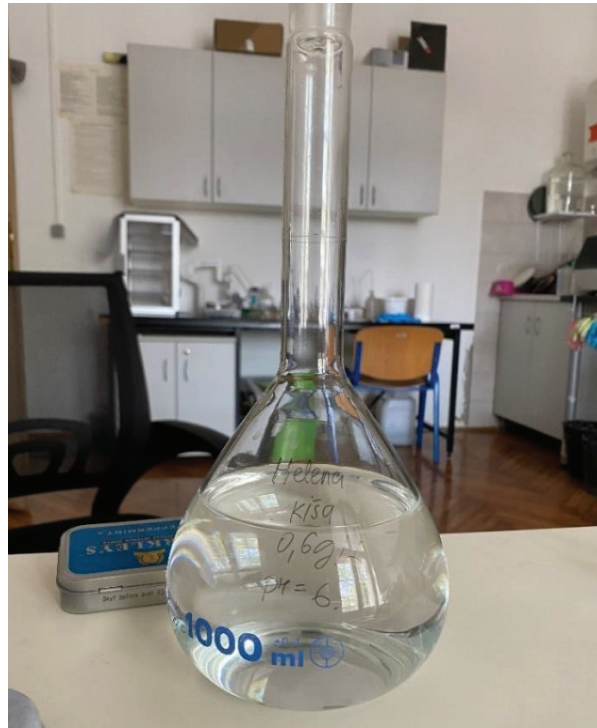
Slika 10. Tekući elektrolit – umjetna kiša
