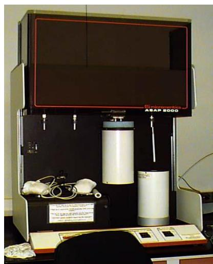
**Slika 3.1.** Uređaj za određivanje veličina pora, ASAP 2000 (*Micromeritics, SAD*)
