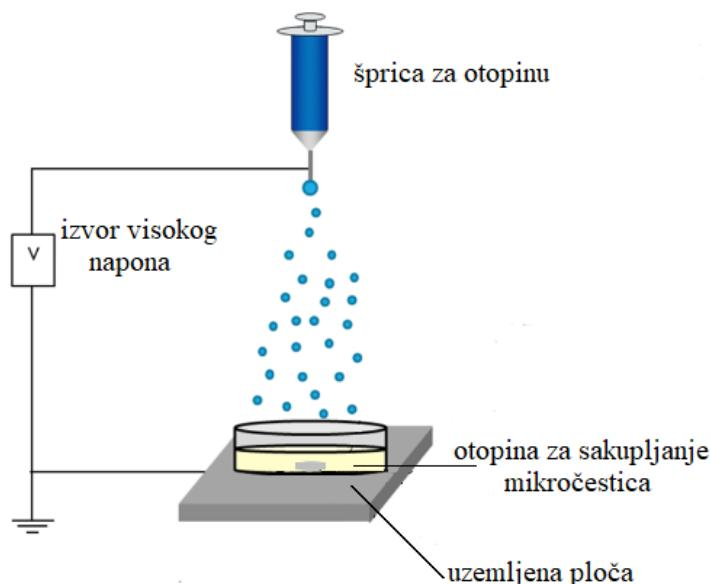
*Slika 4.* Pojednostavljena shema aparature za elektroštrcanje [30]
