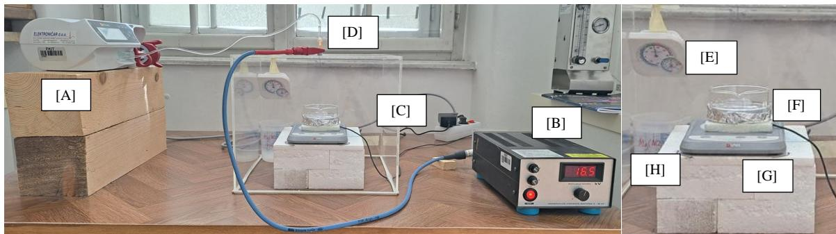
**Slika 11.** Aparatura za elektroštrcanje: [A] pumpa, [B] izvor visokog napona, [C] komora izrađena od poli(metil-metakrilata), [D] metalna igla, [E] senzor temperature i relativne vlažnosti, [F] 50 mL 5 %-tne otopine  $\text{NaOH}$  za sakupljanje mikročestica, [G] magnetska miješalica, [H] zasićena otopina  $\text{Mg}(\text{NO}_3)_2$
