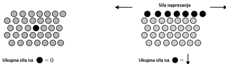
Slika 4. Shematski prikaz raspodjele sile u sustavu. Konstruirano prema referenci 2 .
