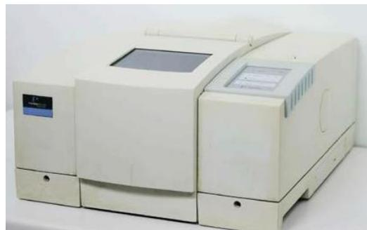
Slika 3.3.1.: FTIR spektrofotometar PerkinElmer Spectrum One
