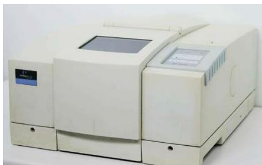
Slika 3.3.1.: FTIR spektrofotometar PerkinElmer Spectrum One
