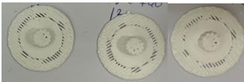
Slika 20. 3D-ispisani model korištenjem PS postavki ispisa (s lijeva na desno): +20 %, +40 %, +50 %
