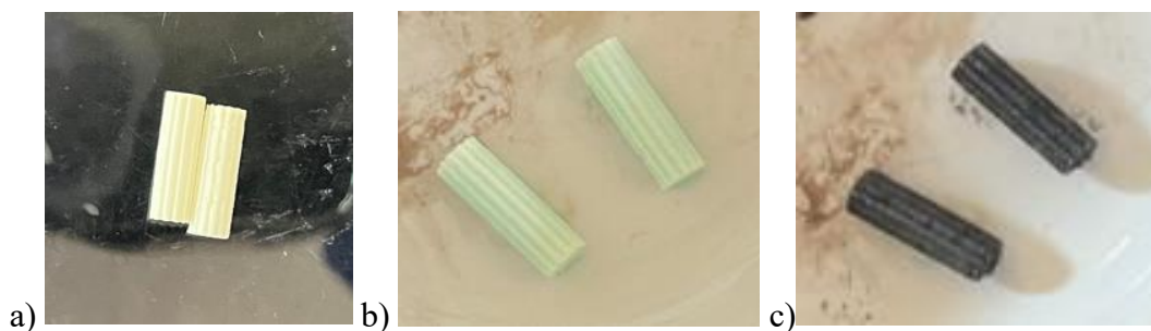
Slika 27. Monolitni nosač katalizatora ZDP geometrije: a) prije impregnacije b) nakon impregnacije u otopini Mn i Cu c) nakon kalciniranja
