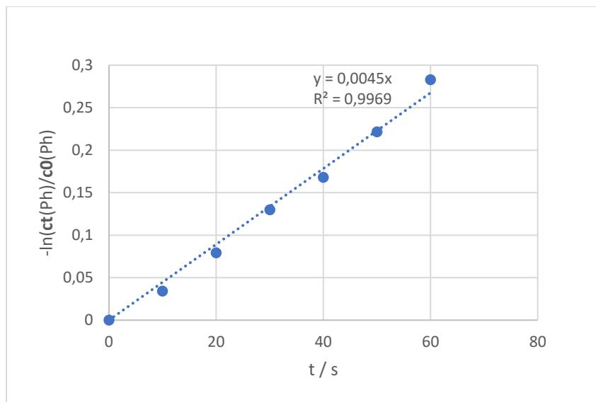
**Slika 13** Određivanje konstante brzine kemijske reakcije pseudo prvog reda za razgradnju fenola kroz 60 s, UVC/H<sub>2</sub>O<sub>2</sub> procesom pri pH 7 te koncentracijom oksidansa od 200 mM
