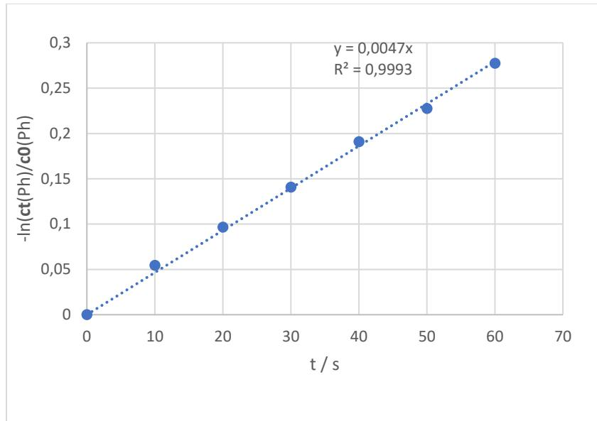
*Slika 9 Određivanje konstante brzine kemijске reakcije pseudo prvog reda za razgradnju fenola kroz 60 s, UVC/H<sub>2</sub>O<sub>2</sub> procesom pri pH 4 te koncentracijom oksidansa od 105 mM*
