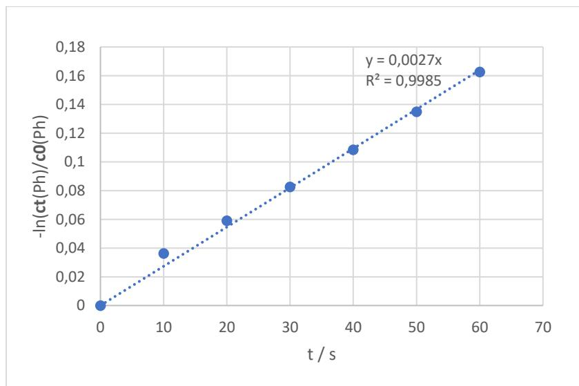
**Slika 16** Određivanje konstante brzine kemijске reakcije pseudo prvog reda za razgradnju fenola kroz 60 s, UVC/H<sub>2</sub>O<sub>2</sub> procesom pri pH 10 te koncentracijom oksidansa od 200 mM
