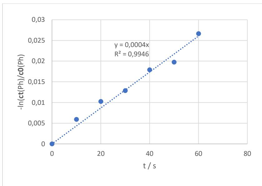
**Slika 23** Određivanje konstante brzine kemijske reakcije pseudo prvog reda za razgradnju fenola kroz 60 s, UVC/S<sub>2</sub>O<sub>8</sub> procesom pri pH 7 te koncentracijom oksidansa od 200 mM
