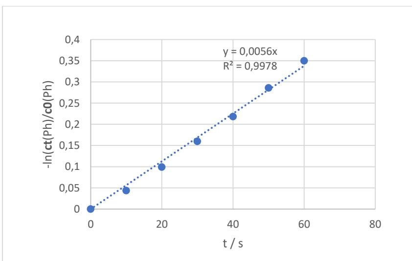
**Slika 12** Određivanje konstante brzine kemijске reakcije pseudo prvog reda za razgradnju fenola kroz 60 s, UVC/H<sub>2</sub>O<sub>2</sub> procesom pri pH 7 te koncentracijom oksidansa od 105 mM
