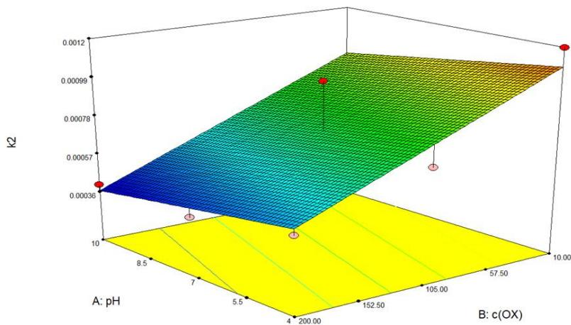
**Slika 27** Trodimenzionalni dijagram utjecaja pH i koncentracije oksidansa na brzinu razgradnje fenola tehnikom UVC/S<sub>2</sub>O<sub>8</sub>
