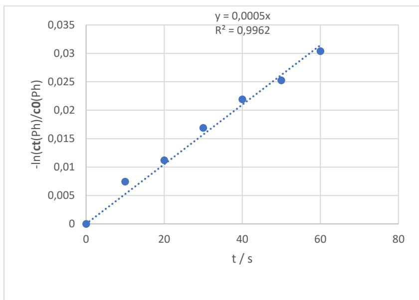
**Slika 20** Određivanje konstante brzine kemijske reakcije pseudo prvog reda za razgradnju fenola kroz 60 s, UVC/S<sub>2</sub>O<sub>8</sub> procesom pri pH 4 te koncentracijom oksidansa od 200 mM
