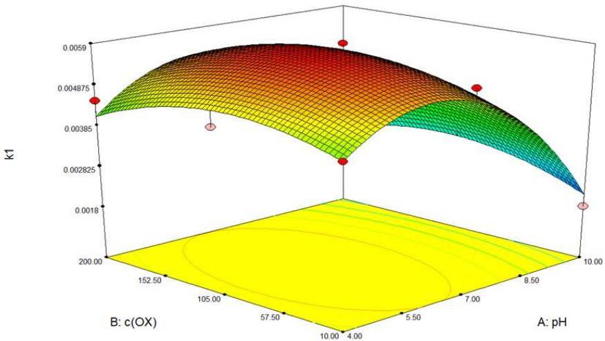
**Slika 17** Trodimenzionalni dijagram zajednočkog utjecaja pH i koncentracije vodikovog peroksida na brzinu razgradnje fenola tehnikom UVC/ $H_2O_2$
