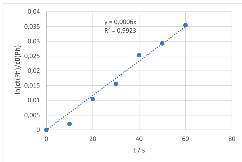
**Slika 25** Određivanje konstante brzine kemijске reakcije pseudo prvog reda za razgradnju fenola kroz 60 s, UVC/S<sub>2</sub>O<sub>8</sub> procesom pri pH 10 te koncentracijom oksidansa od 105 mM
