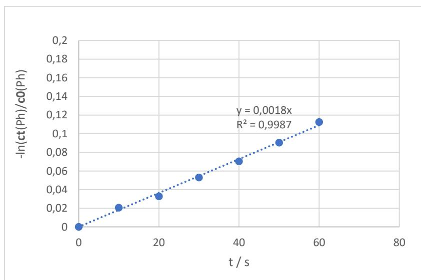
**Slika 14** Određivanje konstante brzine kemijske reakcije pseudo prvog reda za razgradnju fenola kroz 60 s, UVC/H<sub>2</sub>O<sub>2</sub> procesom pri pH 10 te koncentracijom oksidansa od 10 mM
