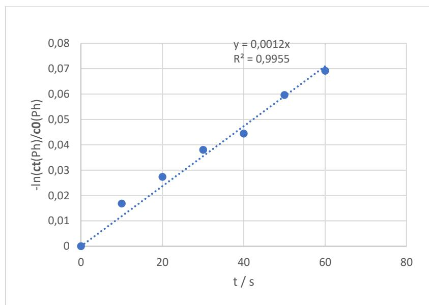
*Slika 18 Određivanje konstante brzine kemiske reakcije pseudo prvog reda za razgradnju fenola kroz 60 s, UVC/S<sub>2</sub>O<sub>8</sub> procesom pri pH 4 te koncentracijom oksidansa od 10 mM*
