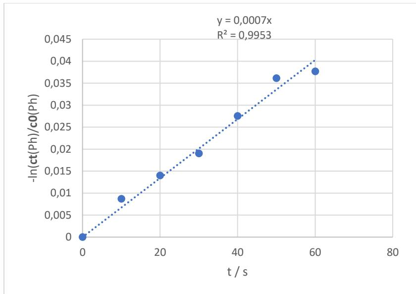
**Slika 19** Određivanje konstante brzine kemijske reakcije pseudo prvog reda za razgradnju fenola kroz 60 s, UVC/S<sub>2</sub>O<sub>8</sub> procesom pri pH 4 te koncentracijom oksidansa od 105 mM
