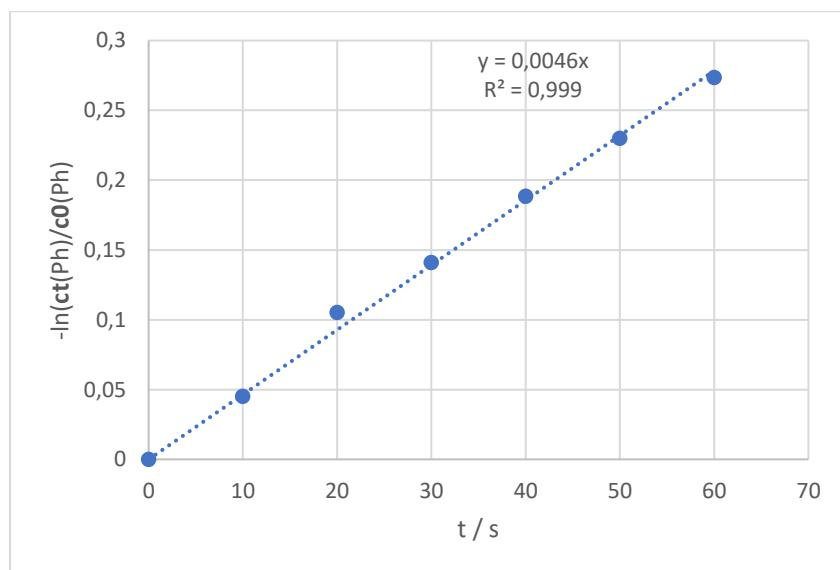
*Slika 10 Određivanje konstante brzine kemijске reakcije pseudo prvog reda za razgradnju fenola kroz 60 s, UVC/H<sub>2</sub>O<sub>2</sub> procesom pri pH 4 te koncentracijom oksidansa od 200 mM*
