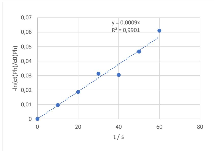
**Slika 21** Određivanje konstante brzine kemijske reakcije pseudo prvog reda za razgradnju fenola kroz 60 s, UVC/S<sub>2</sub>O<sub>8</sub> procesom pri pH 7 te koncentracijom oksidansa od 10 mM
