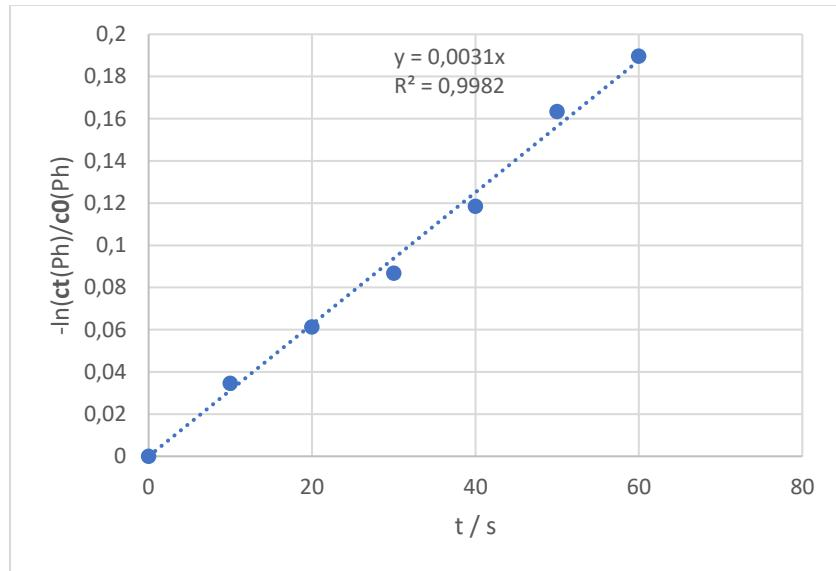
**Slika 15** Određivanje konstante brzine kemijске reakcije pseudo prvog reda za razgradnju fenola kroz 60 s, UVC/H<sub>2</sub>O<sub>2</sub> procesom pri pH 10 te koncentracijom oksidansa od 105 mM
