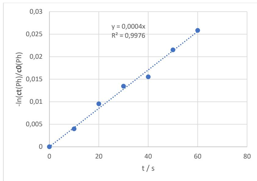
**Slika 26** Određivanje konstante brzine kemiske reakcije pseudo prvog reda za razgradnju fenola kroz 60 s, UVC/S<sub>2</sub>O<sub>8</sub> procesom pri pH 10 te koncentracijom oksidansa od 200 mM
