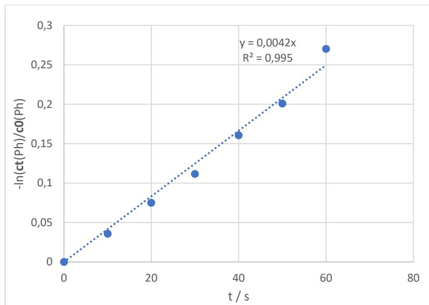
*Slika 8 Određivanje konstante brzine kemijske reakcije pseudo prvog reda za razgradnju fenola kroz 60 s, UVC/ $H_2O_2$  procesom pri pH 4 te koncentraciji oksidansa od 10 mM*
