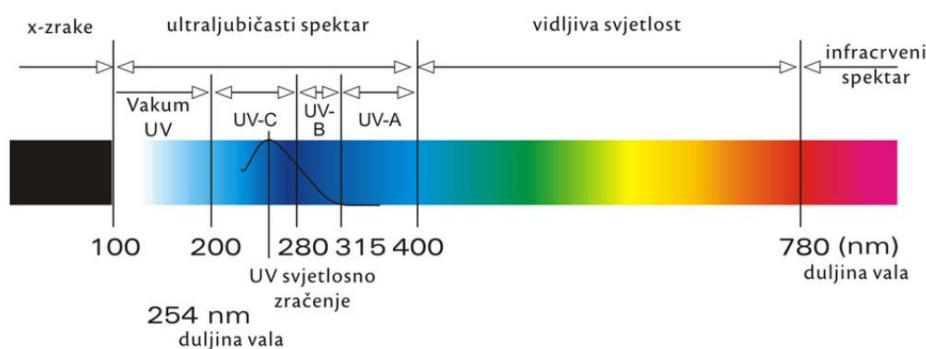
*Slika 3 UV-Vidljivi spektar elektromagnetskog zračenja [14]*
