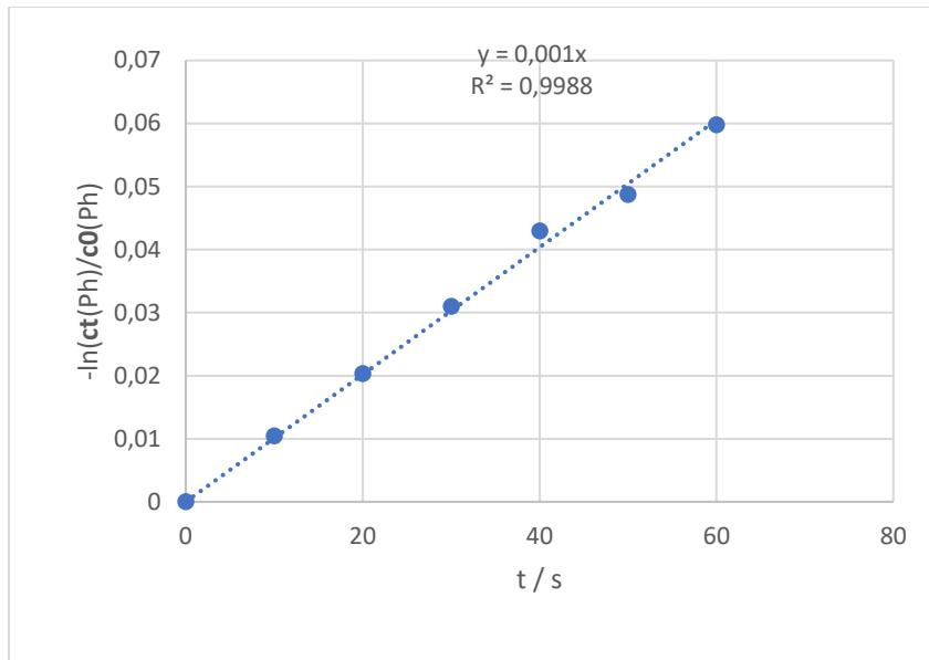
**Slika 22** Određivanje konstante brzine kemijske reakcije pseudo prvog reda za razgradnju fenola kroz 60 s, UVC/S<sub>2</sub>O<sub>8</sub> procesom pri pH 7 te koncentracijom oksidansa od 105 mM
