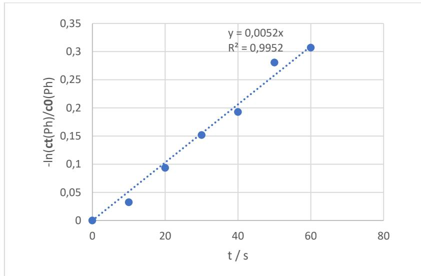
**Slika 11** Određivanje konstante brzine kemijске reakcije pseudo prvog reda za razgradnju fenola kroz 60 s, UVC/H<sub>2</sub>O<sub>2</sub> procesom pri pH 7 te koncentracijom oksidansa od 10 mM
