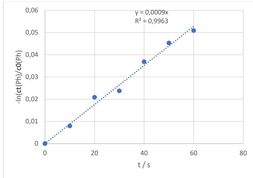
**Slika 24** Određivanje konstante brzine kemijске reakcije pseudo prvog reda za razgradnju fenola kroz 60 s, UVC/S<sub>2</sub>O<sub>8</sub> procesom pri pH 10 te koncentracijom oksidansa od 10 mM
