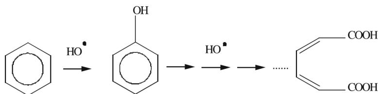
*Slika 2 Reakcijska shema hidroksilacije aromatskog prtena hidroksilnim radikalom te otvaranje prtena dalnjim napadom hidroksilnog radikala [12]*
