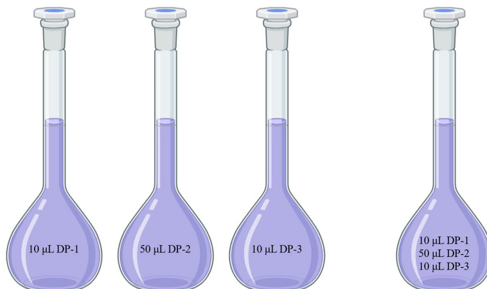
Slika 15. Otopine korištene za kvalitativnu HPLC-DAD analizu
