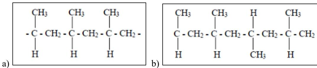
**Slika 2.3.** Strukturna formula a) izotaktičkog polipropilena, b) ataktičkog polipropilena
