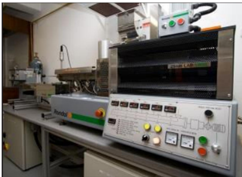
Slika 3.1. Dvopužni ekstruder RONDOL BenchTop 21 mm, UK
