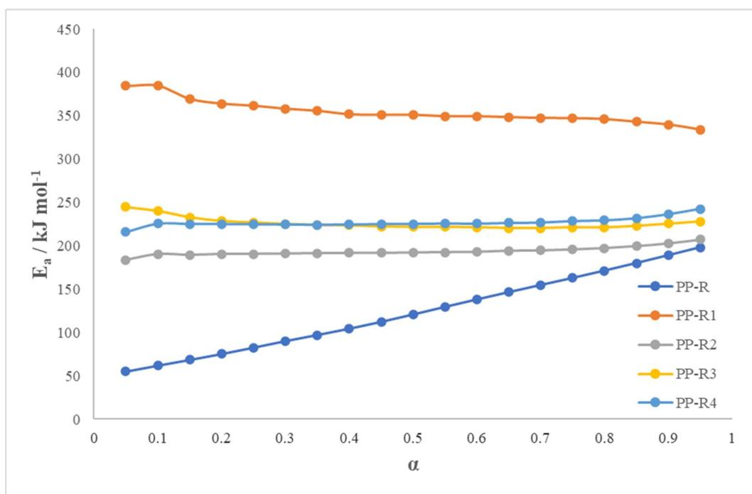
**Slika 4.11.** Ovisnost energije aktivacije dinamičke toplinske razgradnje o konverziji prije i nakon svakog ciklusa recikliranja PP uzorka
