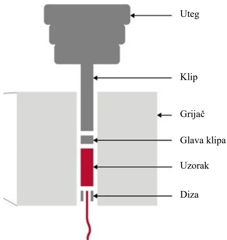
**Slika 2.11.** Shema aparature za ispitivanje brzine protjecanja taljevine
