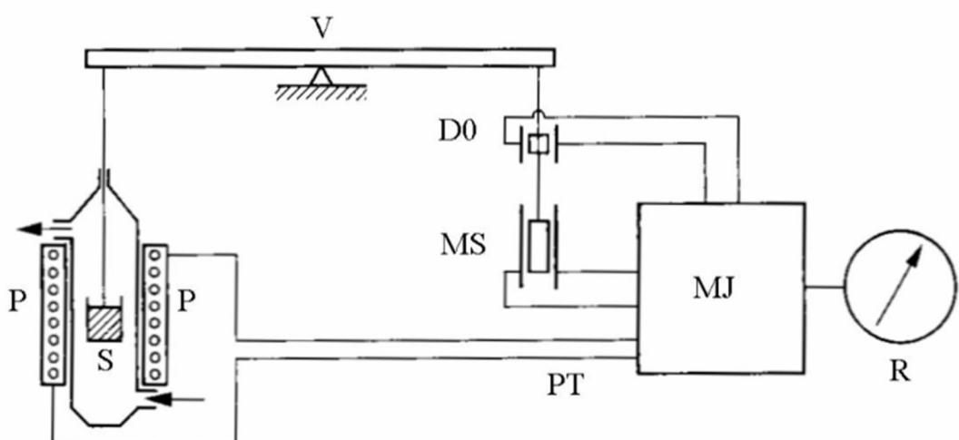
**Slika 2.12.** Shema TG uređaja: V-vaga, S-uzorak, P-peć, PT-programiranje temperature, D0-detektor nulte točke, MS-magnetski svitak za kompenzaciju mase, MJ-modularna jedinica, R-registracijski uređaj
