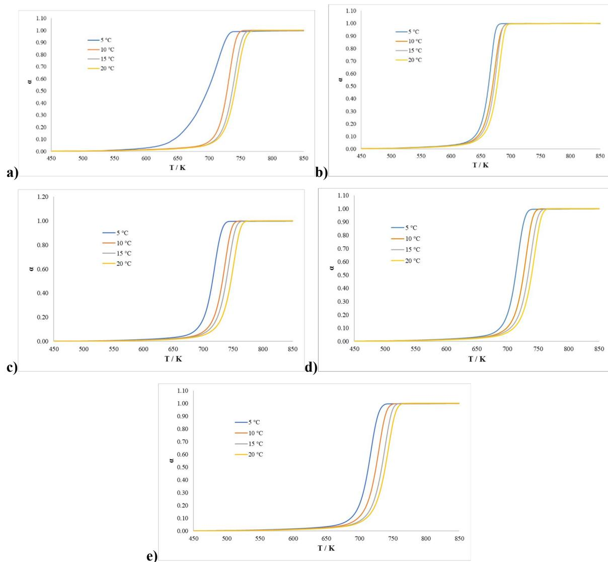
**Slika 4.9.** Ovisnost konverzije ( $\alpha$ ) o temperaturi ( $T$ ) za različite brzine zagrijavanja za uzorake: **a)** PP-R, **b)** PP-R1, **c)** PP-R2, **d)** PP-R3 i **e)** PP-R4
