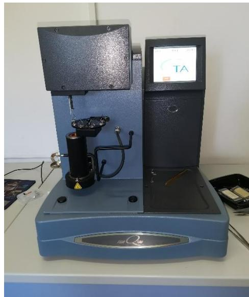
Slika 3.6 TA Instruments Q500 termogravimetar
