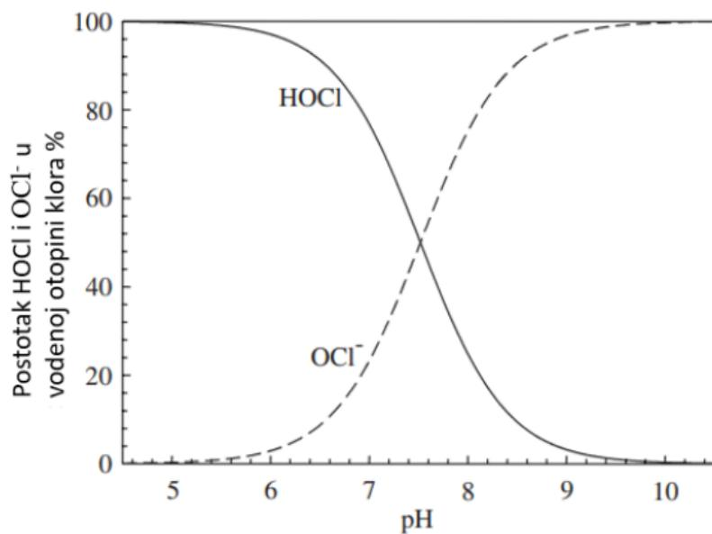
Slika 2.8. Ovisnost HOCl/ $\text{OCl}^-$  omjera o pH vrijednosti ( $\text{p}K_a = 7,5$ ) [24]
