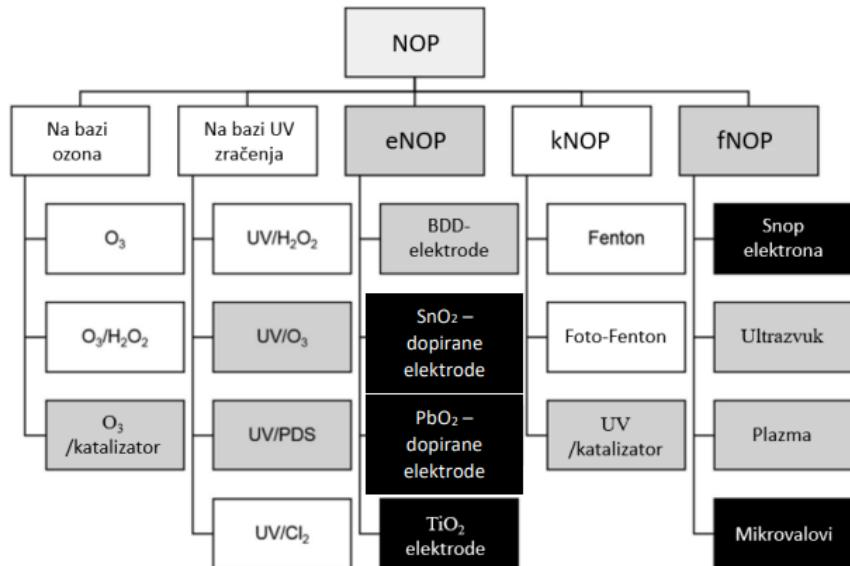
Slika 2.3. Shematski prikaz podjele naprednih oksidacijskih procesa [1]
