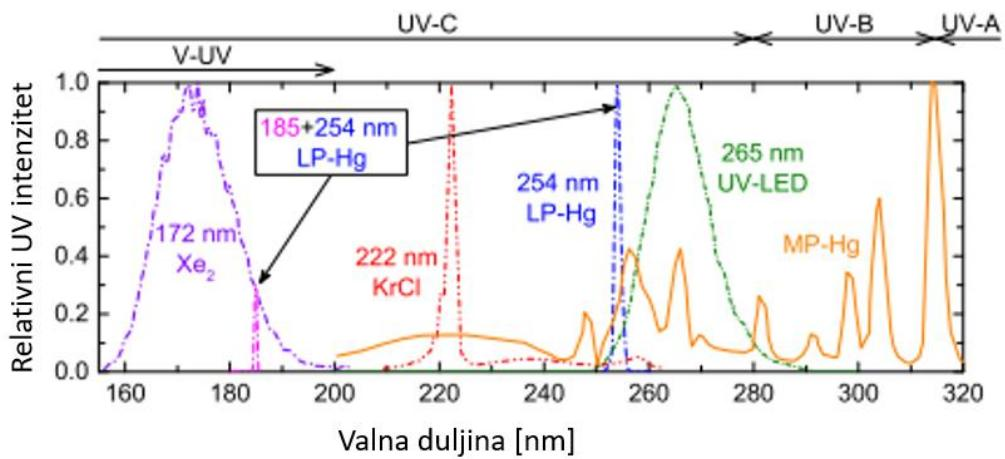
Slika 2.5. Emisijski spektar za ksenonovu lampu ( $Xe_2$ ), KrCl lampu, UV LED lampu te živinu lampu niskog (LP-Hg) i srednjeg (MP-Hg) tlaka [21]
