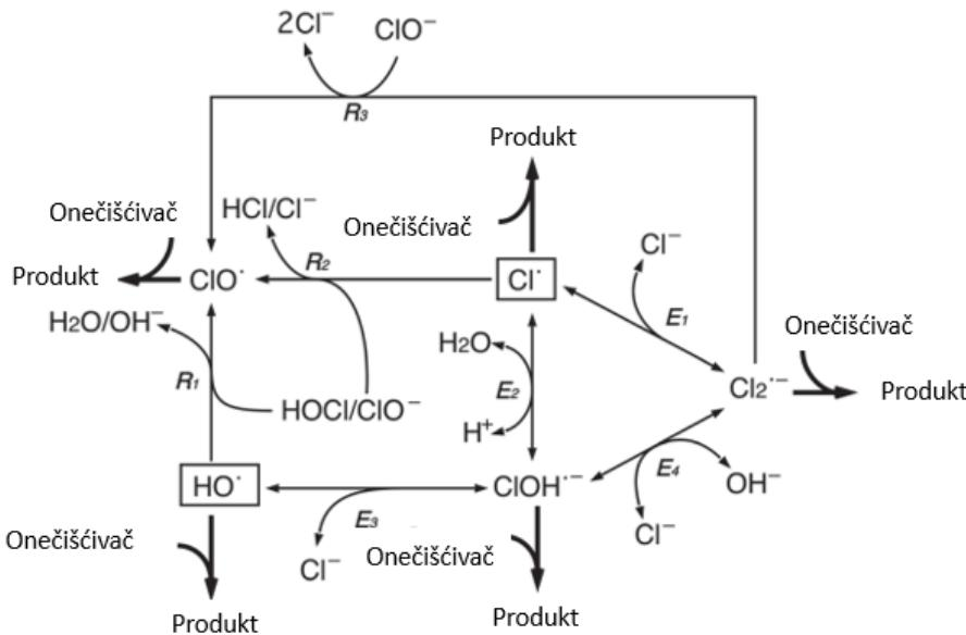
Slika 2.10. Shematski prikaz nastajanja primarnih (u kvadratičima) radikala i sekundarnih radikala u UV/Cl<sub>2</sub> naprednom oksidacijskom procesu [3]
