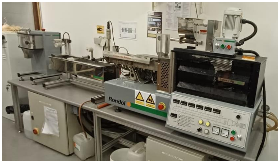
Slika 22. Dvopužni laboratorijski ekstruder, Randol Bench Top 21
