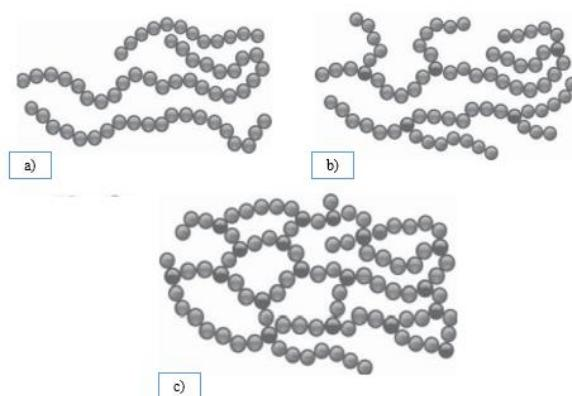
**Slika 2.** Prikaz strukturne podjele polimera na a) lančane polimere, b) polimere razgranatog lanca i c) umrežene polimere [6]
