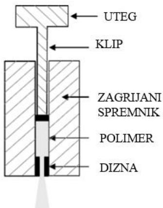
**Slika 17.** Shematski prikaz instrumenta za mjerjenje MFR-a
