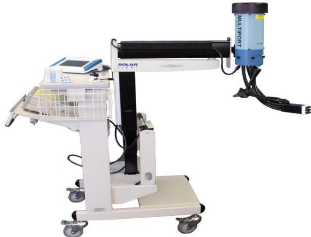
**Slika 29.** Prikaz korištenog solarnog simulatora<sup>51</sup>
