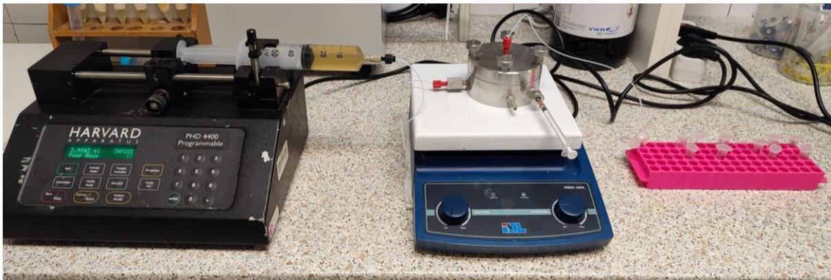
**Slika 8.** Aparatura potrebna za provedbu reakcije fermentacije pomoću membranskog reaktora
