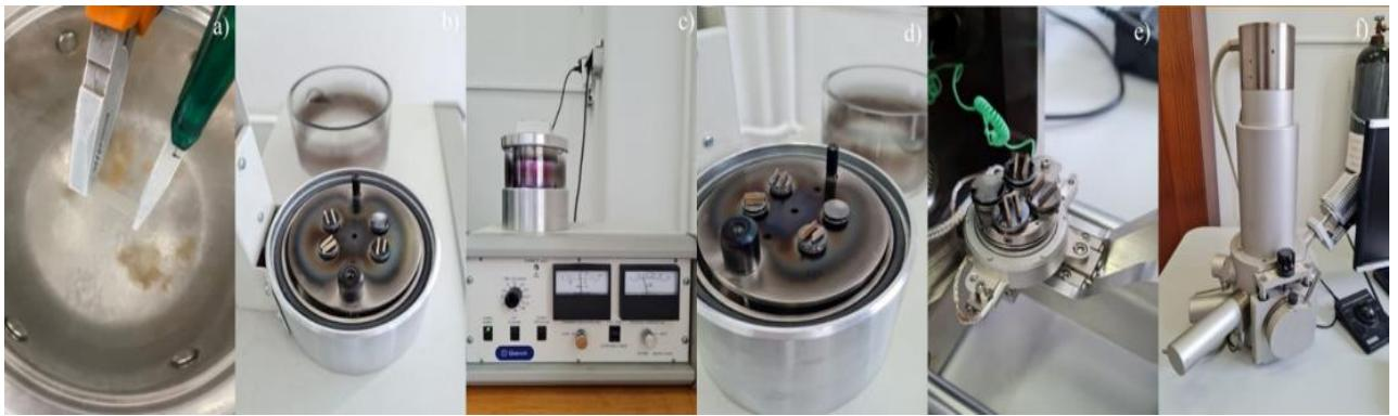
**Slika 19.** Tijek pripreme uzorka za SEM analizu: a) smrzavanje uzorka u tekućem dušiku, b) postavljanje uzoraka na nosače za naparivanje, c) naparivanje uzorka legurom zlata i paladija, d) uzorci nakon naparivanja, e) uzorci neposredno prije analize na SEM-u, f) pretražni elektronski mikroskop, SEM
