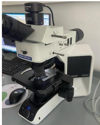
**Slika 23.** Optički mikroskop s polarizacijom
