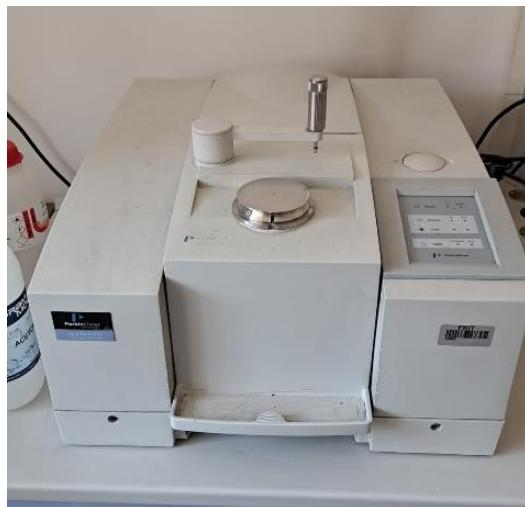
**Slika 20.** FTIR-ATR instrument
