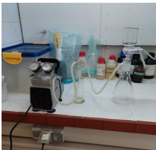
Slika 17. Filtriranje uzoraka pomoću sustava za filtriranje (membranski lijevak i vakuum pumpa)
