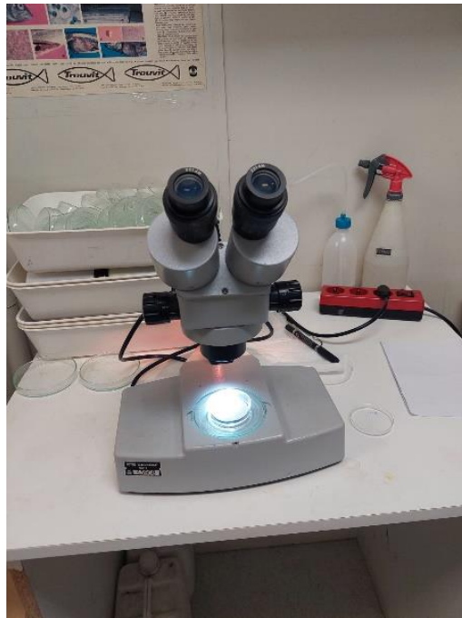
Slika 20. Stereo lupa za promatranje uzoraka pod povećanjem 10-40 puta
