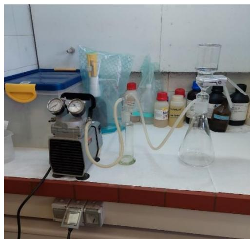
**Slika 17.** Filtiranje uzoraka pomoću sustava za filtriranje (membranski lijevak i vakuum pumpa)
