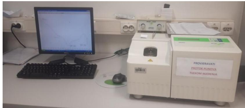
Slika 9. Diferencijalni pretražni kalorimetar, *Mettler Toledo DSC 823e*.
