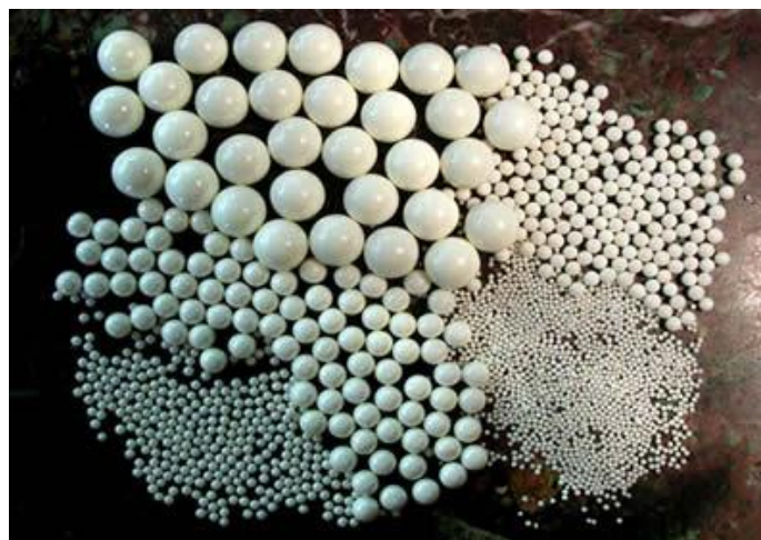
Slika 12. Keramičke kuglice za usitnjavanje različitih promjera
