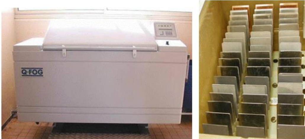
Slika 3. Aparatura (lijevo) i uzorci (desno) za provođenje testa slanim sprejom [7]
