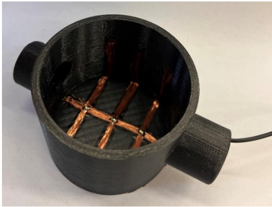
Slika 8. Priprema uzorka: senzorsko kućište (lijevo), armatura (desno)
