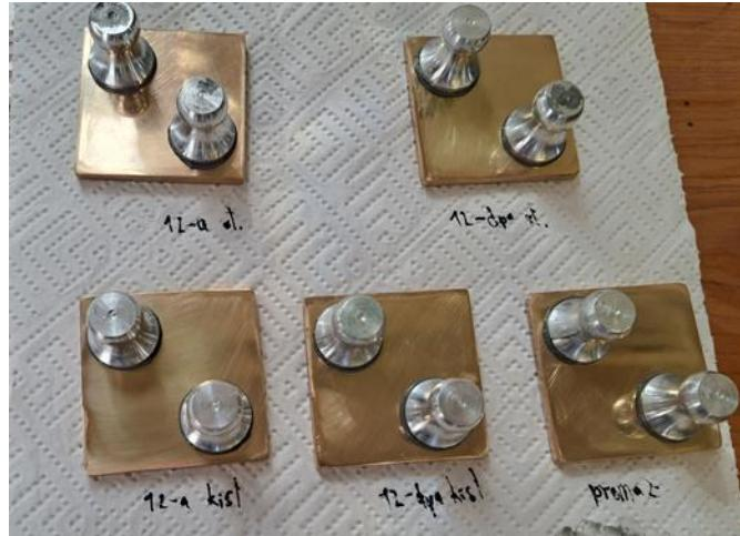
**Slika 14.** Pločice s pričvršćenim čunjićima za pull-off test
