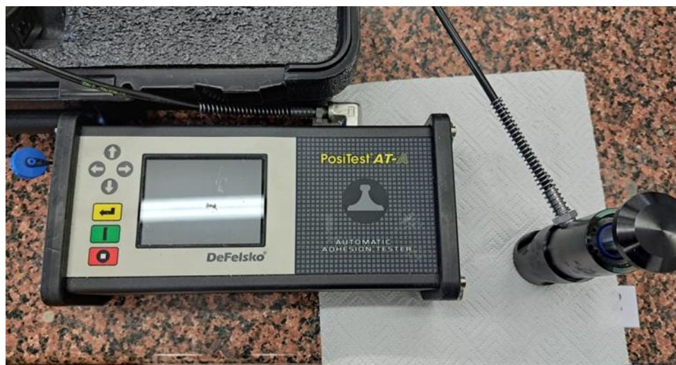
**Slika 15.** PosiTector AT-A, uređaj za izvođenje pull-off testa
