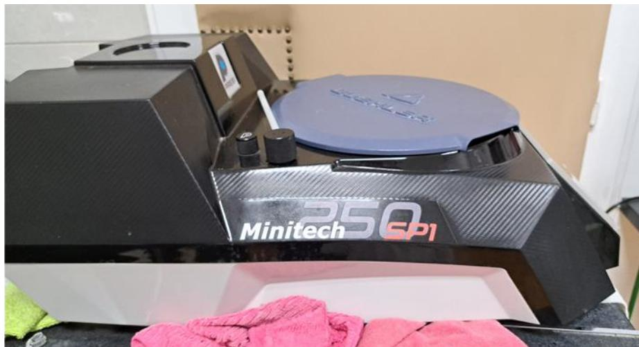
**Slika 9.** Aparat za poliranje Minitech 250 SP1
