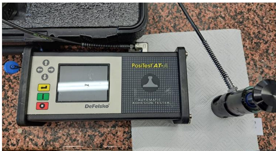
Slika 15. PosiTest AT-A, uređaj za izvođenje pull-off testa
