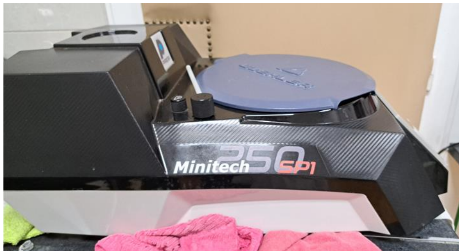
Slika 9. Aparat za poliranje Minitech 250 SP1
