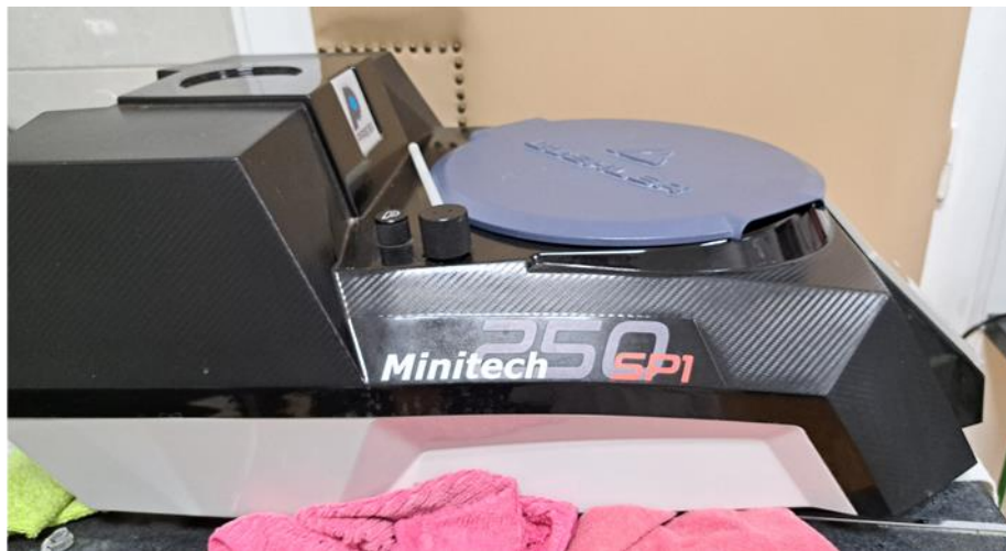
Slika 9. Aparat za poliranje Minitech 250 SP1
