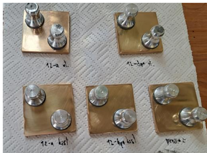
Slika 14. Pločice s pričvršćenim čunjićima za pull-off test
