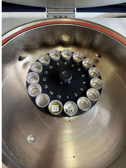
Slika 15. Korišteni nosač uzorka s kalibracijskim uzorkom
