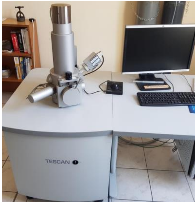
Slika 17. SEM Tescan Vega 3 Easyprobe
