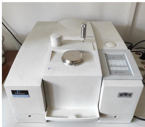
Slika 14. FTIR spektrometar, Perkin Elmer Spectrum One Spectrometer
