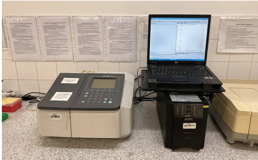
Slika 17. Spektrofotometar UV-1800 proizvođača Shimadzu
