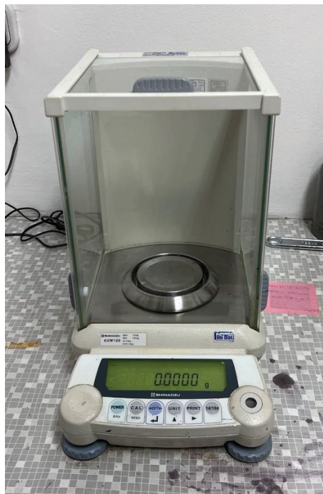
Slika 12. Analitička vaga proizvođača Shimadzu
