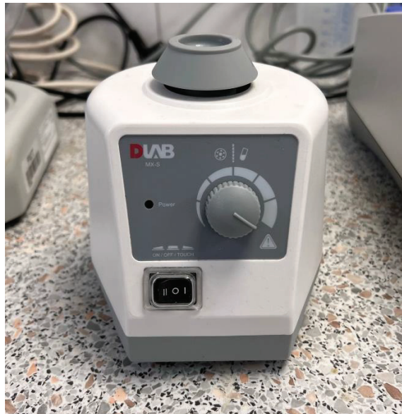
Slika 15. Homogenizator MX-S proizvođača DLAB
