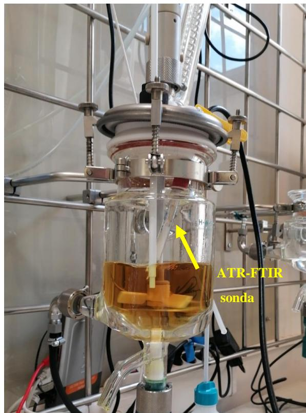
Slika 22. Kristalizator s plaštem, miješalom i ATR-FTIR sondom
