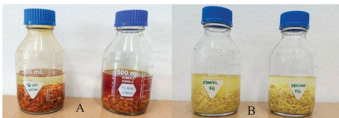
Slika 19. A) maceracija kurkume u heksanu (lijevo) i etanolu (desno) i B) maceracija đumbira u etanolu (lijevo) i heksanu (desno)
