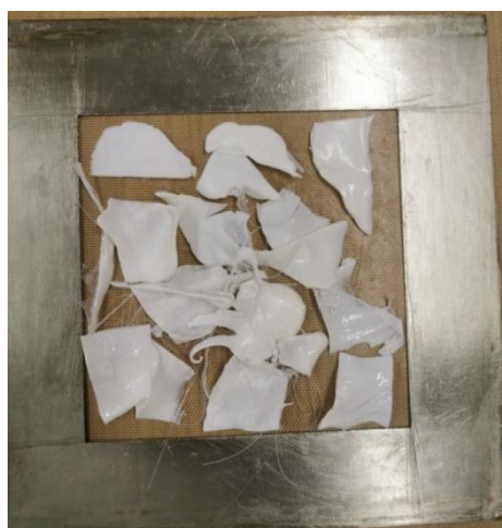
Slika 13. Priprava pločica u kalupu
