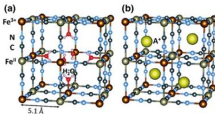
Slika 5. Strukturni oblici PB: a) netopiva pruska plava,  $\text{Fe}_4[\text{Fe}(\text{CN})_6]_3 \cdot x\text{H}_2\text{O}$ ,
