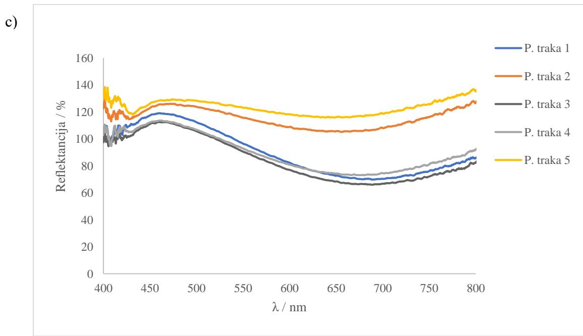
Slika 33. Reflektancijski spektri vezani uz ponovljivost papirnih traka pri: a) pH = 9, b) pH = 10 i c) pH = 11.
