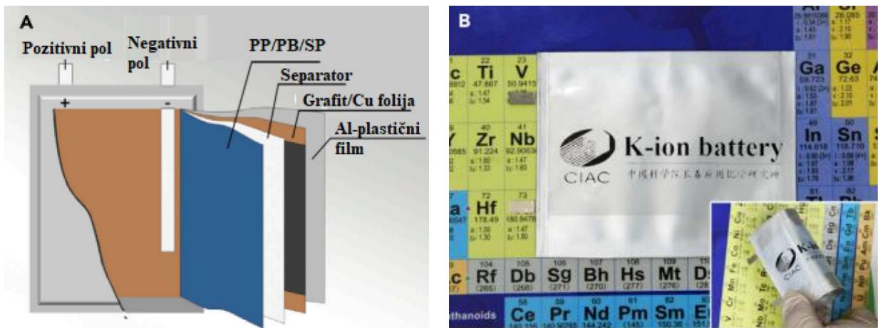
Slika 14. a) Shematski prikaz strukture fleksibilnih KIB-ova, b) Fotografije proizvedenih, fleksibilnih KIB-ova<sup>132</sup>.
