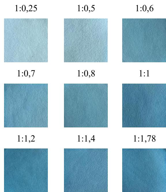
Slika 29. Papirne trake dobivene ispitivanjem utjecaja promjene koncentracije citrata u sinteznoj otopini.
