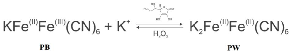
Slika 15. Shema reverzibilne pretvorbe PB u PW<sup>133</sup>.
