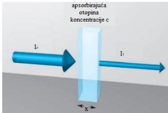
Slika 4. Slabljenje snopa zračenja apsorpcijom otopine<sup>75</sup>.
