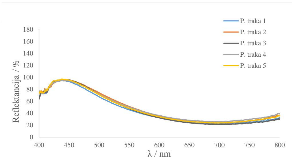
Slika 31. Reflektancijski spektri vezani uz ponovljivost papirnih traka pri: a) pH = 5, b) pH = 6,
