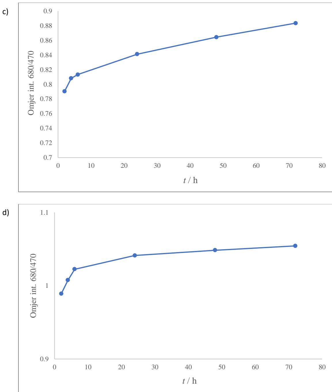
Slika 39. Test stabilnosti papirnih traka berlinskog modrila za: a) pH = 5, b) pH = 7, c) pH = 9 i d) pH = 11.
