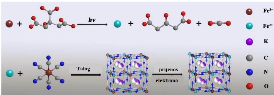
Slika 11. Shematski prikaz mehanizma reakcije cijanotipije<sup>132</sup>.
