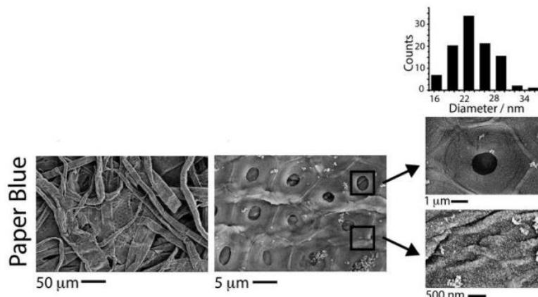
Slika 10. SEM mikrografija PBNP na filter papiru<sup>131</sup>.
