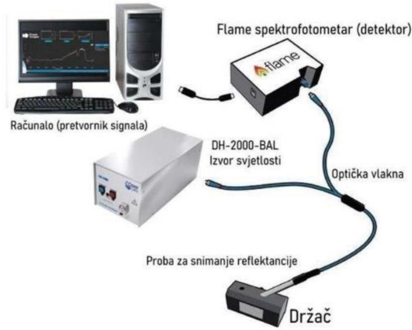
Slika 18. Prikaz uređaja *Ocean Optics Flame* korištenog za mjerjenje reflektancije.
