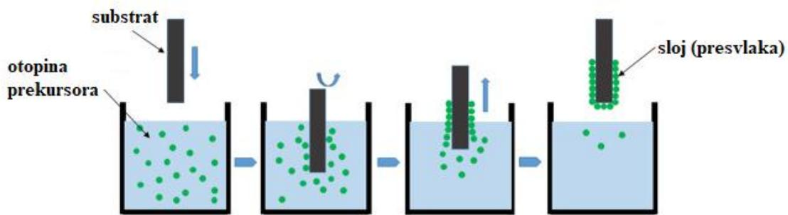
Slika 3. Izvođenje *dip coating* metode<sup>63</sup>.
