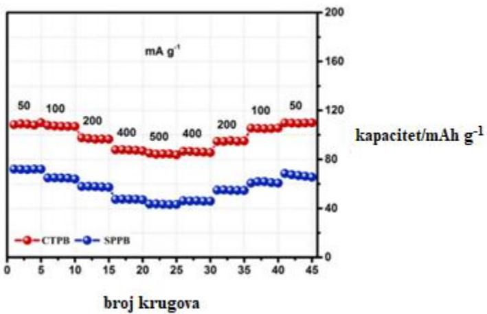
Slika 12. Promjena kapaciteta elektrode načinjene od visoko kristalnih kocki berlinskog modrila pri različitim gustoćama struje od 50 do 500 mA g⁻¹<sup>132</sup>.
