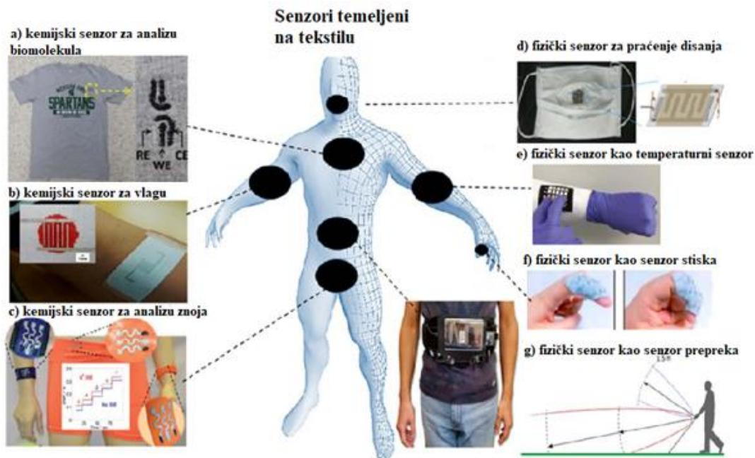
Slika 2. Dvije glavne primjene senzora temeljenih na tekstilu: kemijski senzori (a - c)<sup>48,49,50</sup> i fizički senzori (d - g)<sup>51,52,53,54</sup>.
