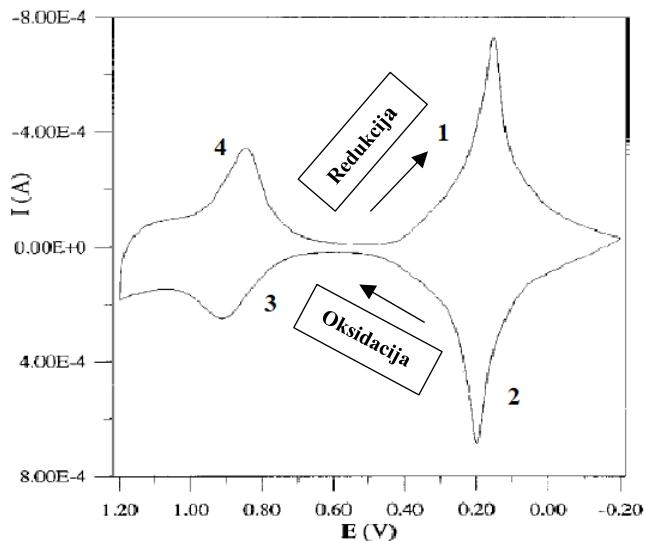
Slika 6. Ciklički voltamogram PB na ITO elektrodi<sup>103</sup>.
