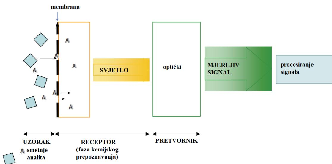
Slika 1. Shematski prikaz načina rada optičkog kemijskog senzora<sup>2</sup>.
