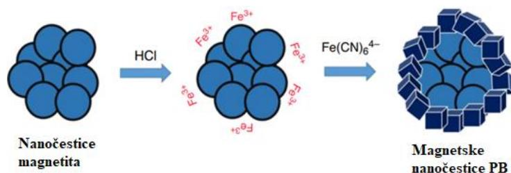
Slika 9. Shematski prikaz postupka korištenog za izradu magnetskih nanoklastera funkcionaliziranih pomoću PB<sup>130</sup>.
