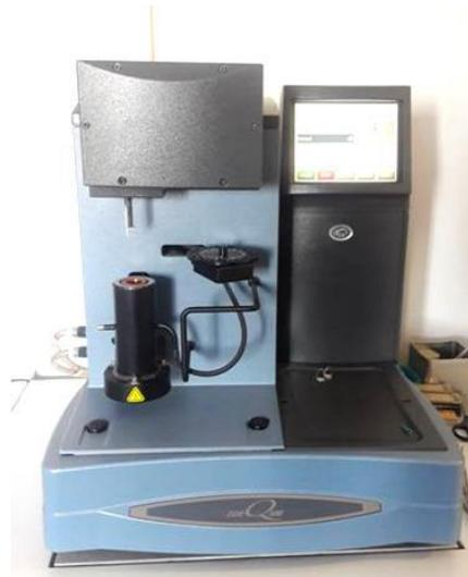
*Slika 24.* Termogravimetar Q500 tvrtke TA Instruments
