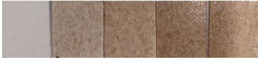
**Slika 21.** Pripremljene pločice PC-a ojačanog vlaknima brnistre u udjelima od 5, 10, 15 i 20 mas. %
