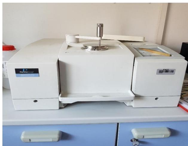
**Slika 26.** Spektrofotometar FT-IR Spectrum One, Perkin Elmer
