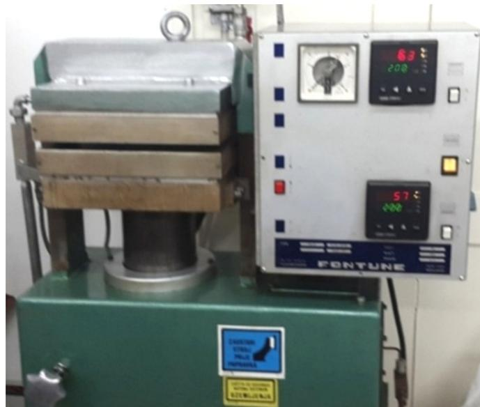
**Slika 17.** Hidraulička preša *Fontune*
