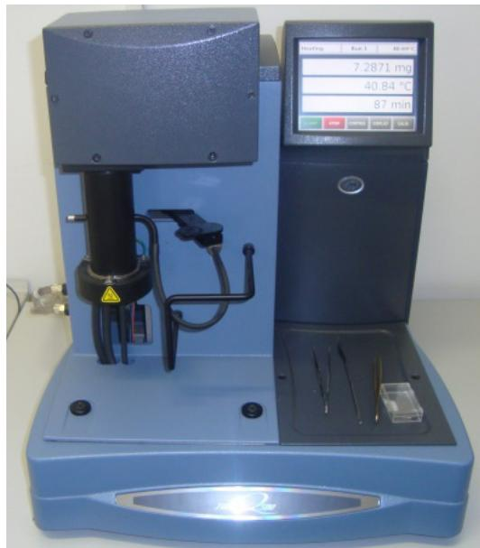
**Slika 21.** Termogravimetar *TA Instruments Q500*
