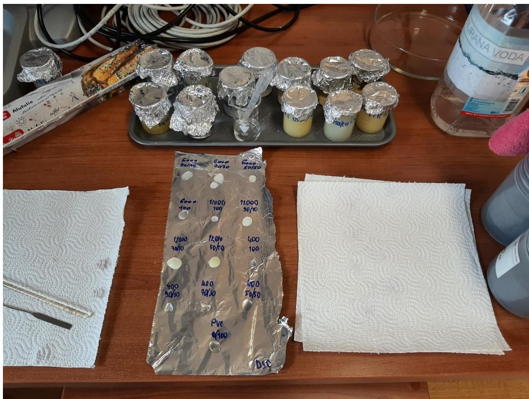
**Slika 15.** Pripravljene otopine PEG/PVP mješavina i priprava uzorka za DSC i TGA analizu.
