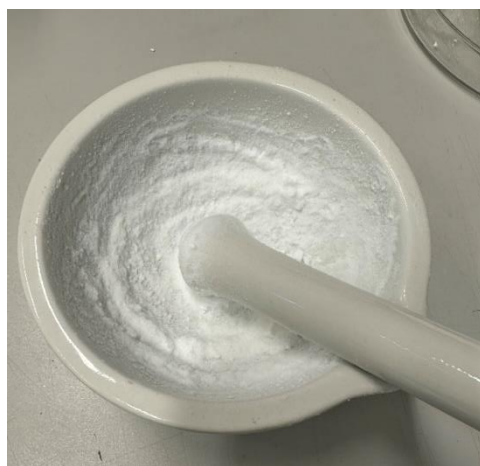
Slika 28. Modifikacija punila, usitnjavanje.
