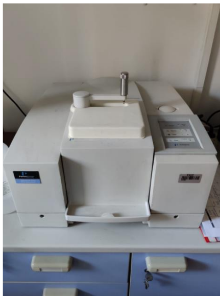
Slika 18. PerkinElmer Spectrum One infracrveni spektrofotometar s Fourierovom transformacijom signala
