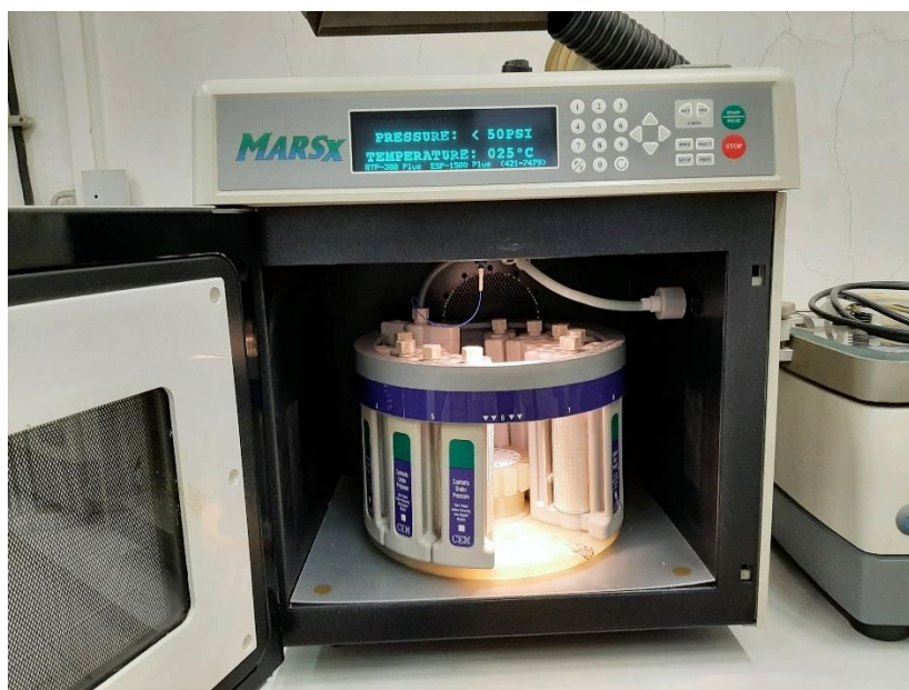
Slika 21. Uređaj za mikrovalnu ekstrakciju s teflonskim posudama za uzorke prije pokretanja ekstrakcije
