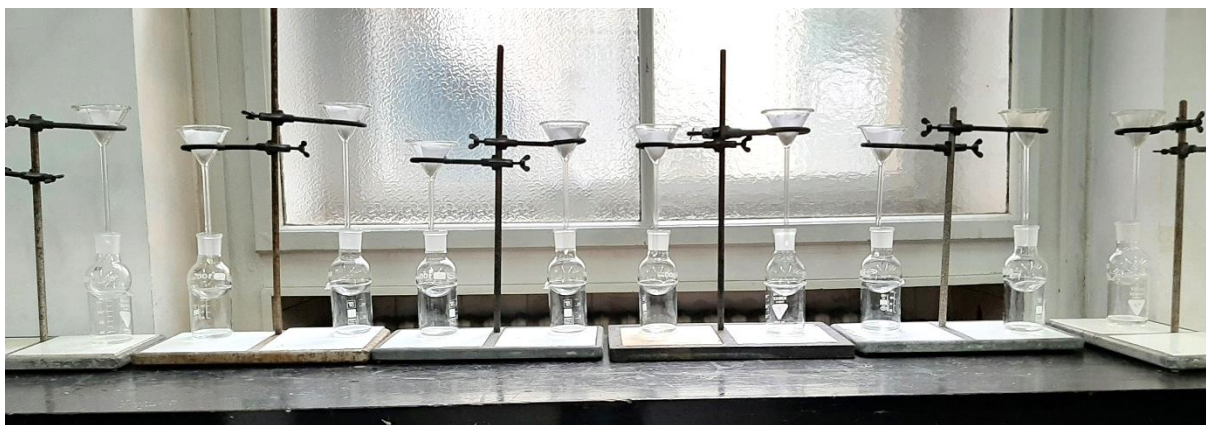
Slika 29. Aparatura za filtraciju uzoraka nakon mikrovalne ekstrakcije
