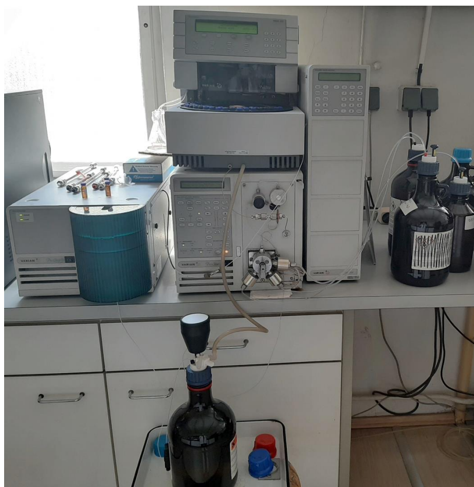
Slika 13. Tekućinski kromatograf visoke djelotvornosti Varian ProStar, SAD
