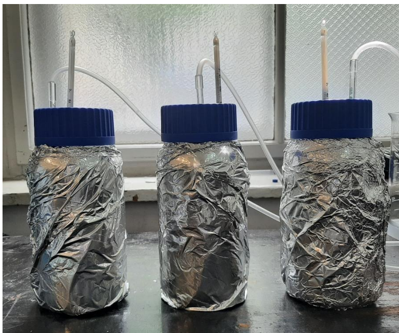
Slika 27. Reaktori u kojima se provodio proces šaržne biorazgradnje
