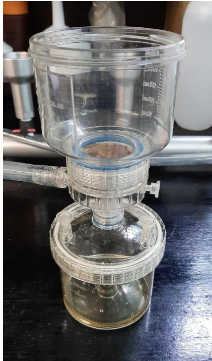
Slika 31. Filter lijevak s vakum sisaljkom
