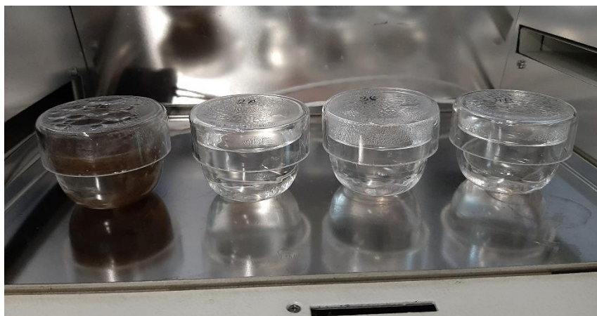
Slika 30. Kvarcne posudice s pripremljenim otopinama za fotolizu
