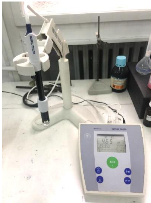
Slika 10. pH metar Seven Easy, Švicarska
