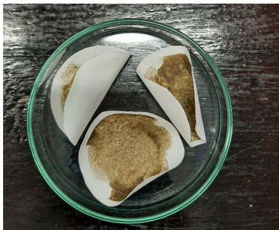
Slika 32. Osušeni uzorci za određivanje suspendiranih čestica u bioreaktoru
