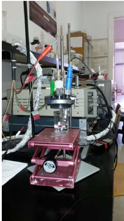
Slika 3.5. Aparatura za elektrokemijska ispitivanja
