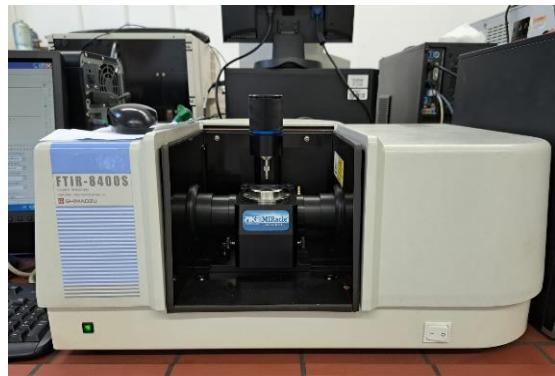
**Slika 3.4.** FTIR-ATR spektrometar.
