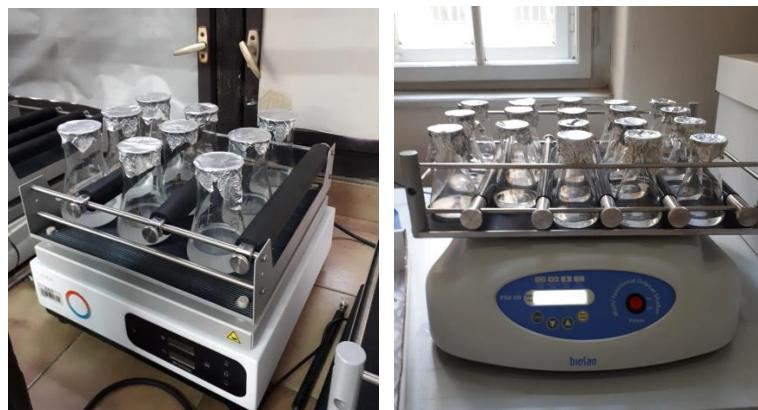
**Slika 3.9.** Postavljene tikvice za provedbu pokusa biorazgradnje PS-a.
