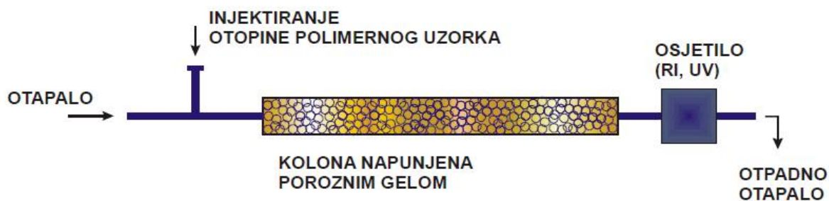
Slika 3.8. Skica SEC/GPC uređaja
