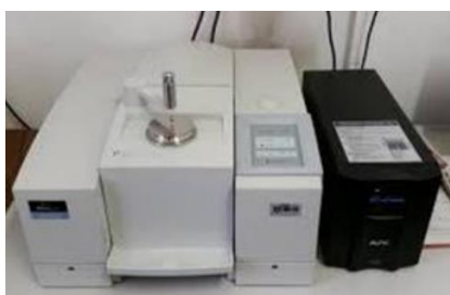
Slika 21. Perkin Elmer Spectrum One spektrometar
