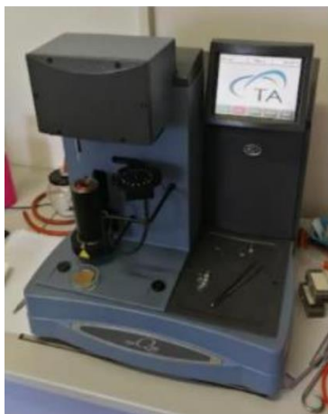
Slika 22. TA Instruments Q500 termogravimetar
