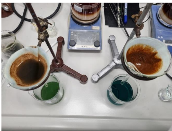
Slika 3.9. Filtracija reakcijske smjese
