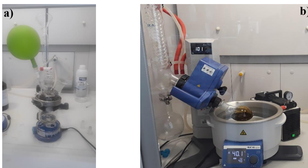
Slika 3.4. a) Sinteza PEDOT-Br makroinicijatora; b) rotacijski uparivač
