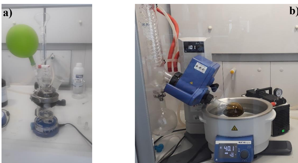
Slika 3.4. a) Sintaza PEDOT-Br makroinicijatora; b) rotacijski uparivač
