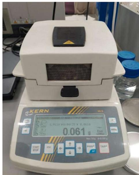
**Slika 18.** Analizator vlage (MLS-50-3C, *Kern & Sohn*).
