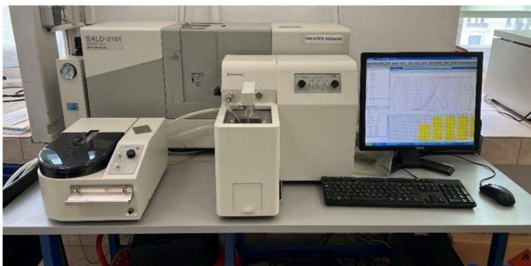
Slika 24. Uređaj za lasersko određivanje raspodjele veličina čestica, Shimadzu Sald 3101 .
