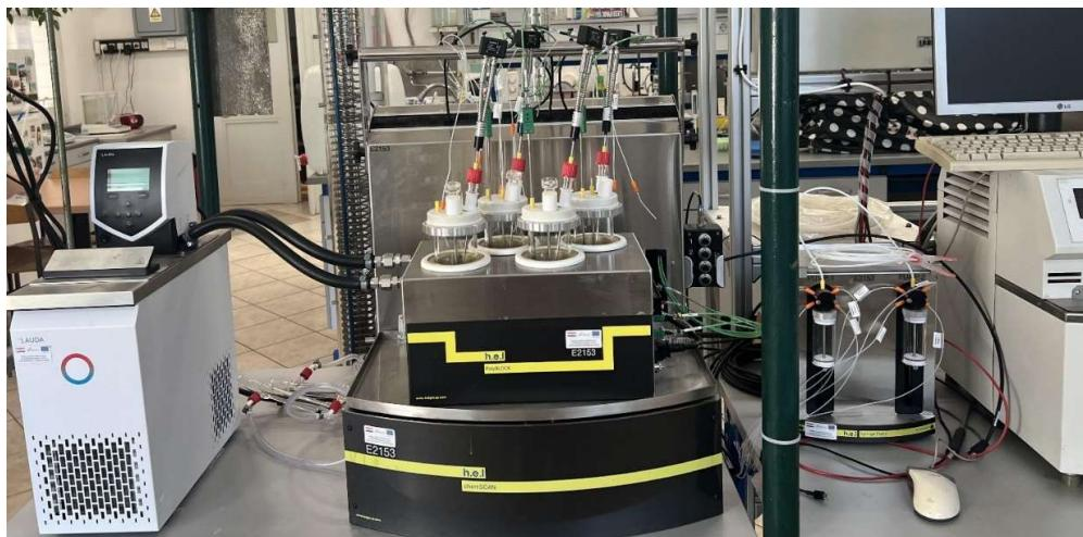
**Slika 16.** Uređaj *CrystaSCAN* korišten za provedbu procesa kristalizacije.
