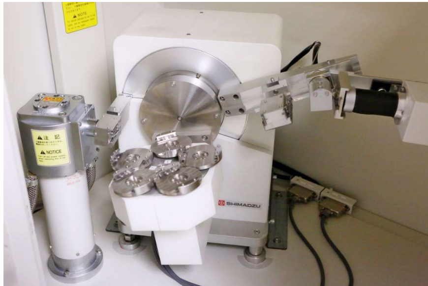
Slika 25. Difraktometar za karakterizaciju kristala, Shimadzu XRD 6000 .
