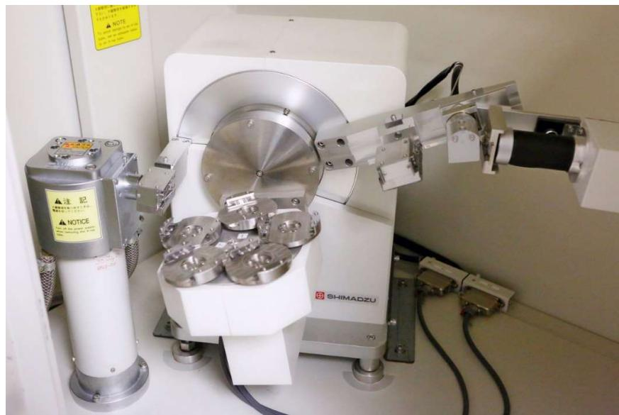
**Slika 25.** Difraktometar za karakterizaciju kristala, *Shimadzu XRD 6000*.
