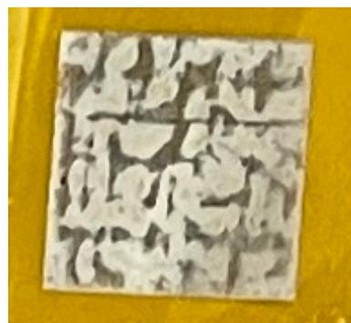
Slika 4.22. Uzorak četiri sloja amfifilne tinte na komercijalnoj PI podlozi obrađen energijom od 1600 J pri 3000 V s tri bljeska.
