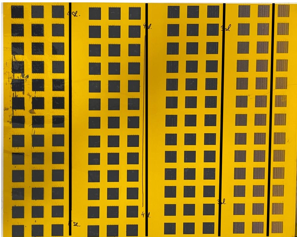
Slika 4.1. Ispis JS-B25HV tinte na PI komercijalnoj podlozi od 5 do 1 slojeva, s lijeva na desno, odvojeni crnim crtama.
