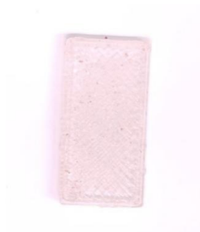
Slika 23. Pločica nakon 10 minuta u otopini: pH 6,1.
