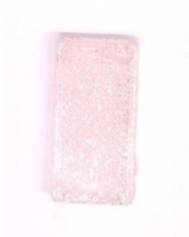
Slika 21. Pločica nakon 10 minuta u otopini: pH 4,0.
