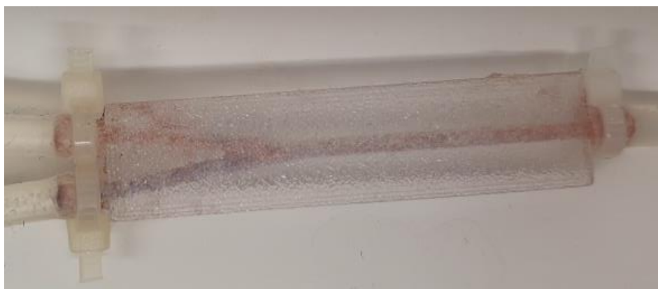
Slika 72. Mikroreaktor 60 s nakon početka protjecanja otopina (protok kiseline: 50 \mu\text{L}/\text{min} ; protok baze: 500 \mu\text{L}/\text{min} ).
