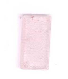
Slika 25. Pločica nakon 10 minuta u otopini: pH 8,1.
