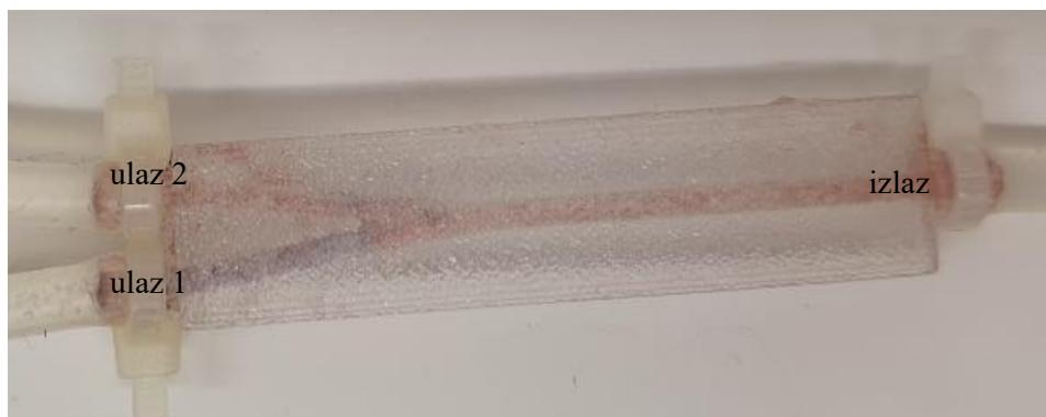
Slika 67. Mikroreaktor 10 s nakon početka protjecanja otopina (protok kiseline: 500  $\mu\text{L}/\text{min}$ ; protok baze: 50  $\mu\text{L}/\text{min}$ ).
