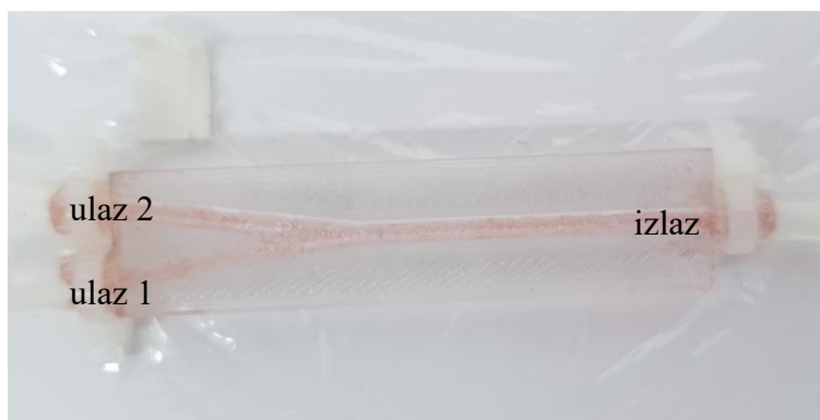
Slika 49. Mikroreaktor prije protjecanja pH otopina.
