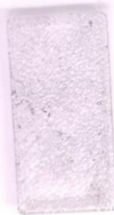
Slika 29. Pločica nakon 10 minuta u otopini: pH 12,0.
