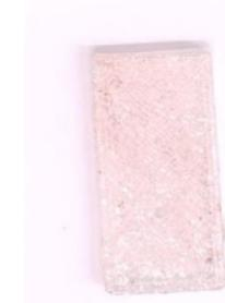
Slika 24. Pločica nakon 10 minuta u otopini: pH 7,0.
