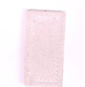
Slika 23. Pločica nakon 10 minuta u otopini: pH 6,1.
