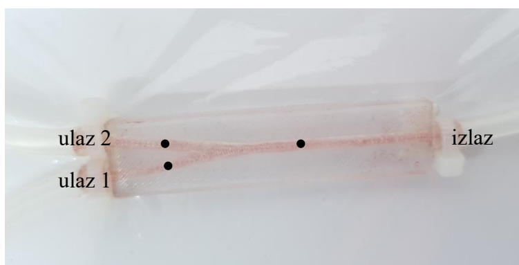
Slika 31. Mikroreaktor prije protjecanja pH otopina.
