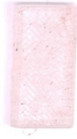
Slika 26. Pločica nakon 10 minuta u otopini: pH 9,0.
