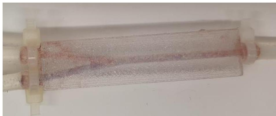
Slika 73. Mikroreaktor 70 s nakon početka protjecanja otopina (protok kiseline: 50  $\mu$ L/min; protok baze: 500  $\mu$ L/min).
