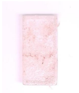
Slika 19. Pločica nakon 10 minuta u otopini: pH 2,1.
