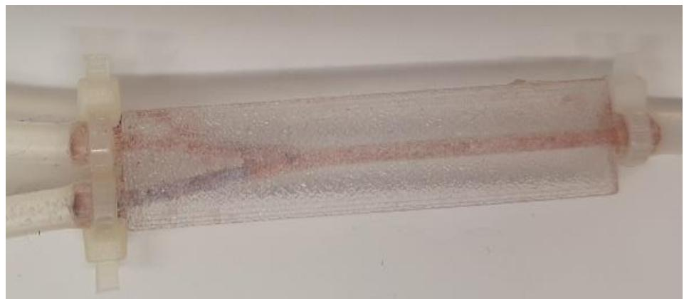
Slika 69. Mikroreaktor 30 s nakon početka protjecanja otopina (protok kiseline: 500  $\mu\text{L}/\text{min}$ ; protok baze: 50  $\mu\text{L}/\text{min}$ ).
