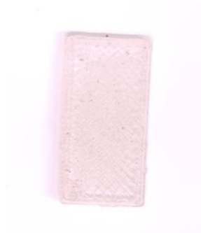
Slika 23. Pločica nakon 10 minuta u otopini: pH 6,1.
