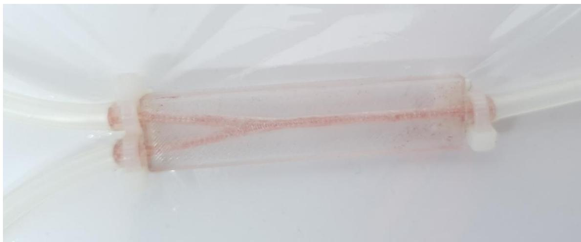
Slika 18. Prikaz ispitivanja filmova u kanalima mikroreaktora.
