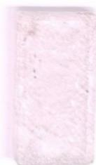
Slika 27. Pločica nakon 10 minuta u otopini: pH 10,0.
