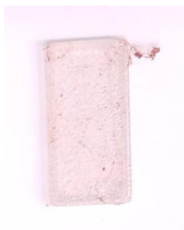
Slika 22. Pločica nakon 10 minuta u otopini: pH 5,0.
