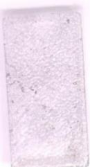
Slika 29. Pločica nakon 10 minuta u otopini: pH 12,0.
