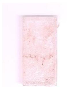
Slika 19. Pločica nakon 10 minuta u otopini: pH 2,1.
