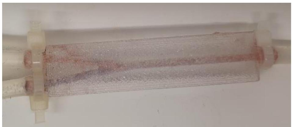
Slika 72. Mikroreaktor 60 s nakon početka protjecanja otopina (protok kiseline: 50  $\mu$ L/min; protok baze: 500  $\mu$ L/min).
