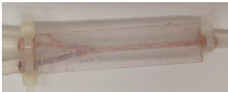
Slika 68. Mikroreaktor 20 s nakon početka protjecanja otopina (protok kiseline: 500  $\mu\text{L}/\text{min}$ ; protok baze: 50  $\mu\text{L}/\text{min}$ ).
