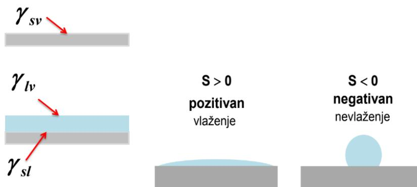
Slika 13. Shematski prikaz ovisnosti koeficijenta razlijevanja, S, i slobodnih energija površina<sup>20</sup>
