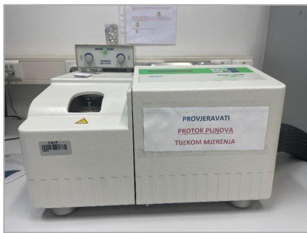
Slika 23. DSC uređaj Mettler Toledo DSC 823e
