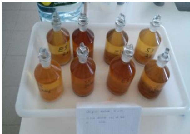
Slika 17. Stvaranje joda kod metode za određivanje otopljenog kisika
