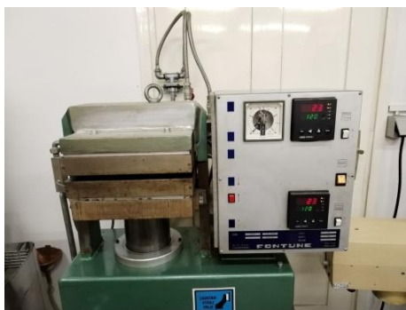
Slika 30. Hidraulička preša Fortune, Holland (SRB 140, EC 320x320NB)
