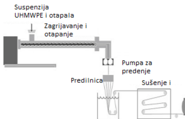
Slika 14. Shematski prikaz procesa pređenja gela [24]
