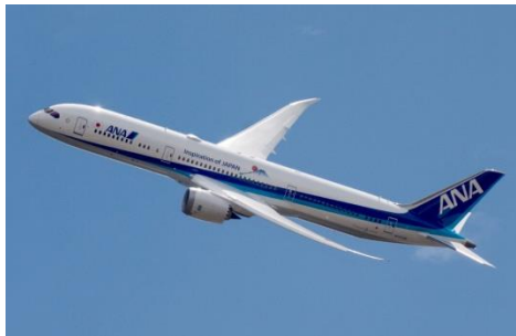
Slika 2. Boeing 787 Dreamliner- prvi zrakoplov većinski izrađen od kompozitnih materijala [5]
