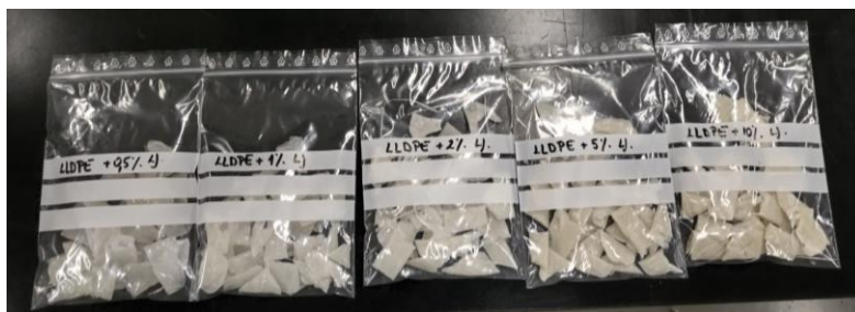
Slika 29. Uzorci LLDPE/LJJ biokompozita nakon umješavanja na Brandeber gnjetilici
