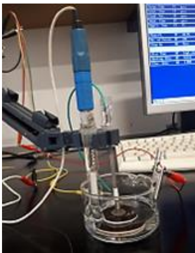
Slika 3.7. Aparatura korištena za redukciju GO papira.
