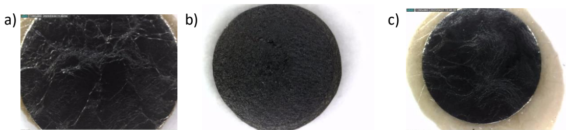
Slika 4.13. Izgled različitih GC elektroda snimljenih optičkim mikroskopom prije depozicije cinka.
